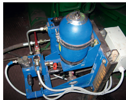
Рис. 8. Блок управления гидравликой
