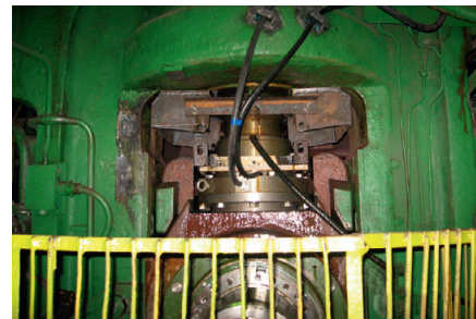
Рис. 7. Мембранные гидрокапсулы, установленные в пазах подушек верхнего валка
