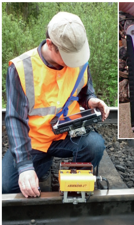
Рис. 9. Специализированный дефектоскоп АВИКОН-17 для обнаружения опасных трещин в головке рельсов под поверхностными повреждениями и для ручного контроля рельсов
