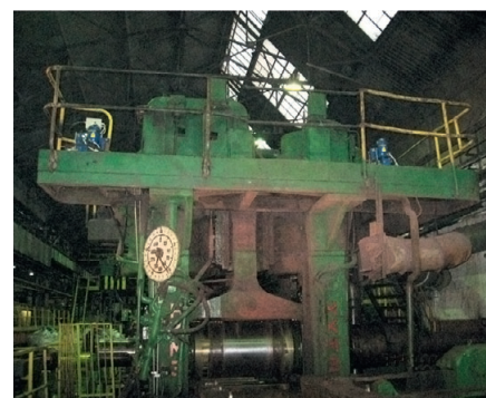
Рис. 1. Рабочая клеть стана ДУО-850
