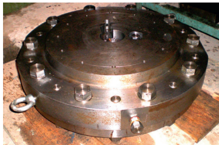
Рис. 10. Гидрокапсула в процессе замены мембраны
