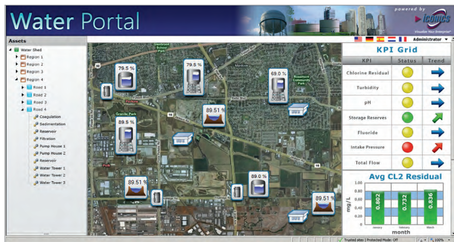
Рис. 2. Система управления активами в проекте водоснабжения Бирмингема
