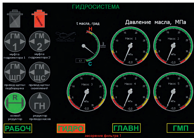
Рис. 7. Аварийное сообщение на экране гидросистемы
