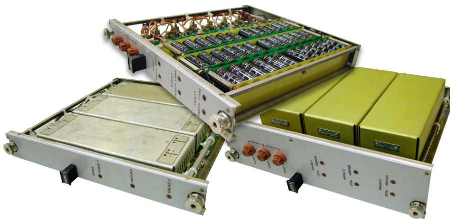
Рис. 6. Блок управления, блок контроля и силовой блок
