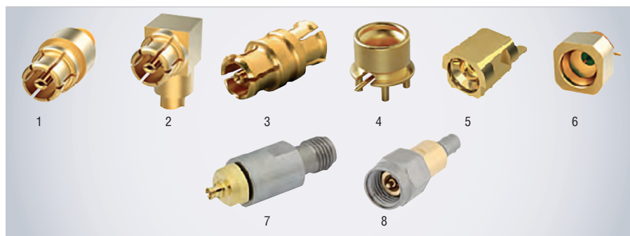
Рис. 2. Соединители SMPM: 1 – прямая кабельная розетка для кабеля 0,047" и 0,085"; 2 – угловая кабельная розетка для кабеля 0,047" и 0,085"; 3 – адаптер SMPM розетка – SMPM розетка («bullet»); 4 – вилка для монтажа в отверстия печатной платы; 5 – концевая вилка для монтажа на печатную плату; 6 – вилка для поверхностного монтажа на печатную плату; 7 – адаптер SMPM розетка – 2,92 мм розетка; 8 – адаптер SMPM вилка – 2,92 мм вилка
