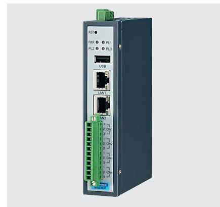
Рис. 3. Интеллектуальный шлюз данных серии ECU-1100
