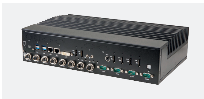
Рис. 1. Транспортный компьютер ADLINK AVA-5500
