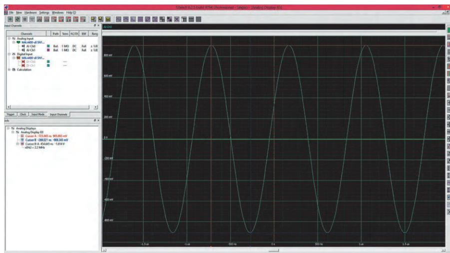
Рис. 45. Два измерительных курсора позволяют проводить прямые измерения внутри каждого окна
