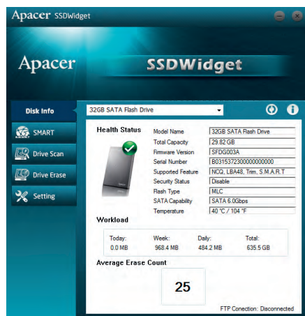
Рис. 6. Информация о текущем состоянии SSD-диска в приложении SSD Widget
