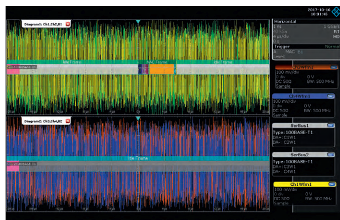
Рис. 3. Декодирование обоих потоков данных стандарта 100BASE-T1 при полнодуплексной передаче данных
