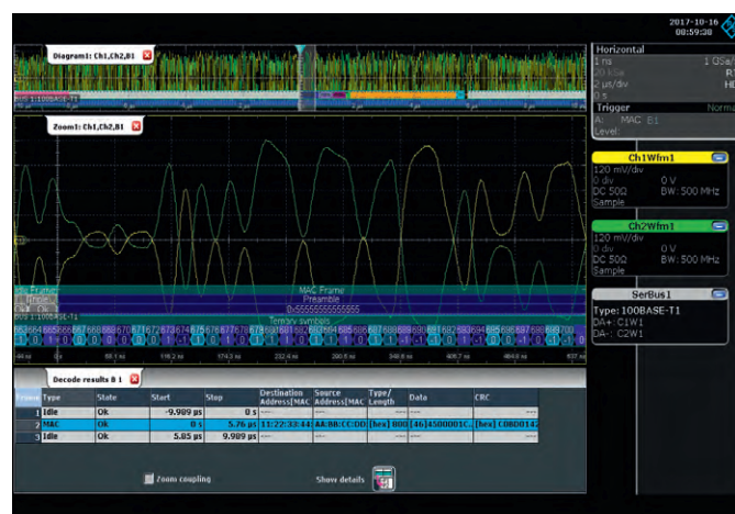
Рис. 4. Декодирование уровней сигнала 100BASE-T1 электрической шины
