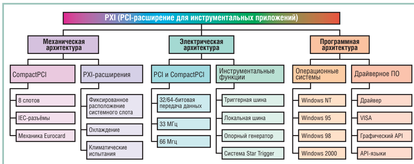
Рис. 4. Программно-аппаратные возможности, определяемые стандартом PXI
