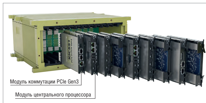
Рис. 3. Модульная структура базового вычислительного блока ГРИФОН
