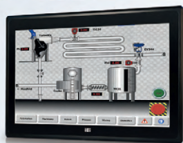
Серия DM-F Промышленный монитор с плоской лицевой панелью и степенью защиты IP65
