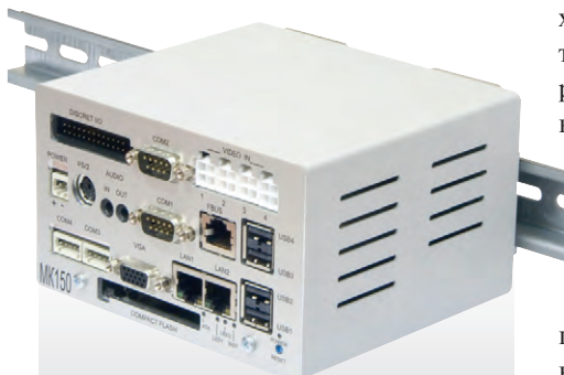
Рис. 5. МК150 – модульный компьютер с интерфейсом FBUS
