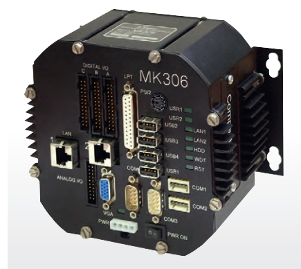
Рис. 2. МК306 – модульный компьютер для АСУ ТП
