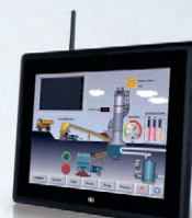
Серия IOVU Панельный ПК для RISC-систем ЧМИ
