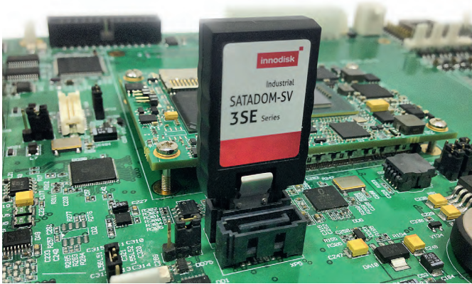
Рис. 3. Накопитель SATADOM с технологией питания Pin 7 VCC
