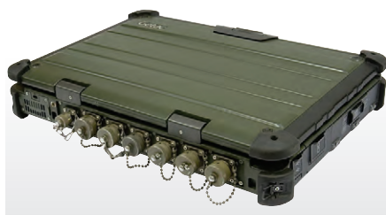
Рис. 9. Байонетные разъёмы X500 MIL CON
