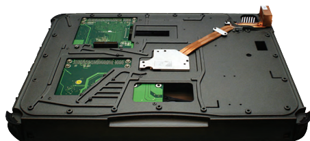
Рис. 5. Расширение PCI x2 для ноутбука X500
