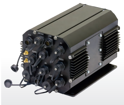
Рис. 3. МК307 – модульный компьютер для применения на транспорте
