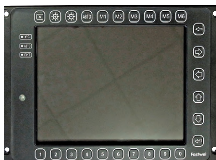
Рис. 1. BM301-02 – интегрированный пульт индикации и управления
