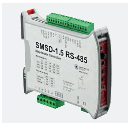
Рис. 6. Внешний вид КИЩ SMSD-1.5 RS-485
