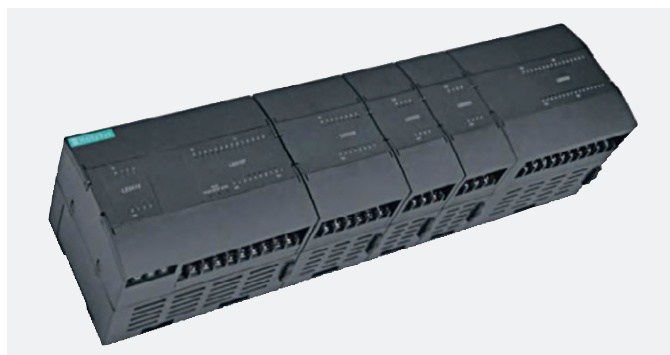
Рис. 2. Внешний вид ПЛК Hollysys серии LE
