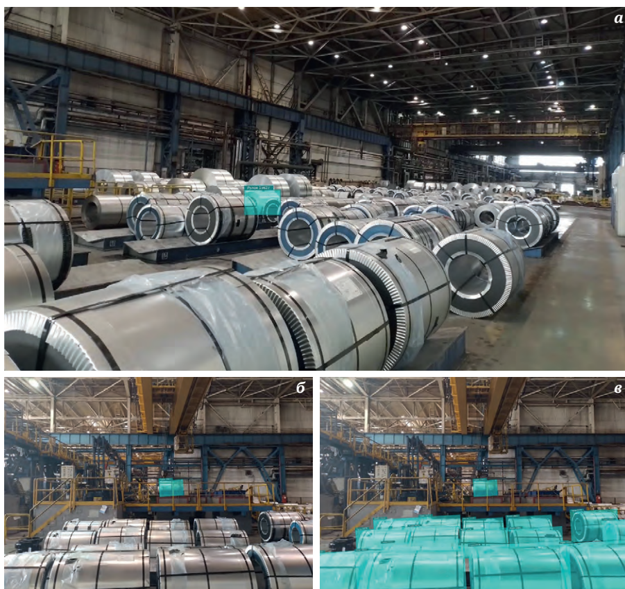
Рис. 2. Результат работы программного обеспечения по слежению за перемещением рулона: отслеживание рулона с определённым номером (2а, 2б); идентификация всех рулонов (2в)
