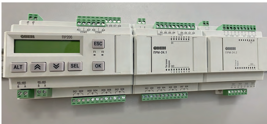
Рис. 4. Внешний вид программируемого реле ПР200 с подключёнными к нему модулями расширения ПРМ-24.1 и ПРМ24.2
