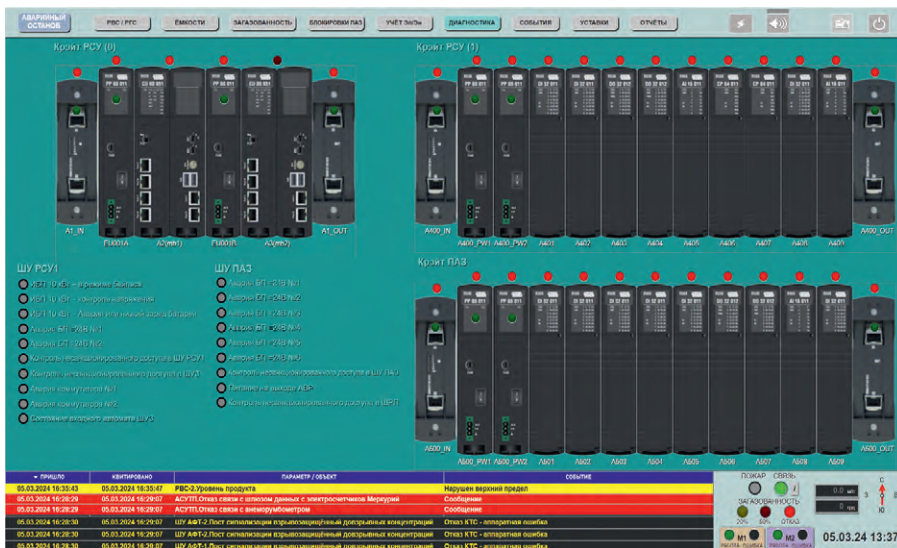
Рис. 1. PCY и СПАЗ в интерфейсе MasterSCADA 4D
