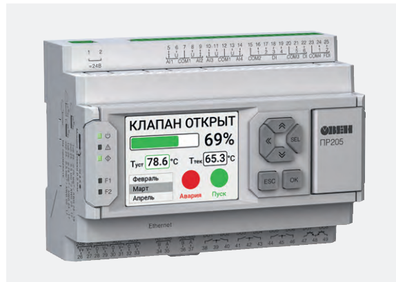
Рис. 3. Внешний вид программируемого реле ПР205
