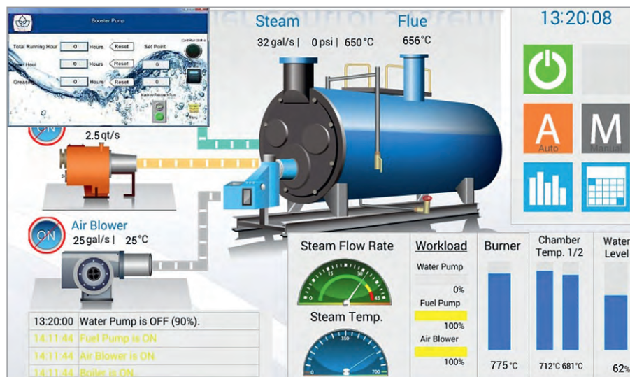
Рис. 7. Экранные формы и среда визуализации ЧМИ Weintek
