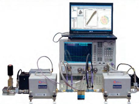
**NVNA, измерения во временной области и измерения X-параметров**
