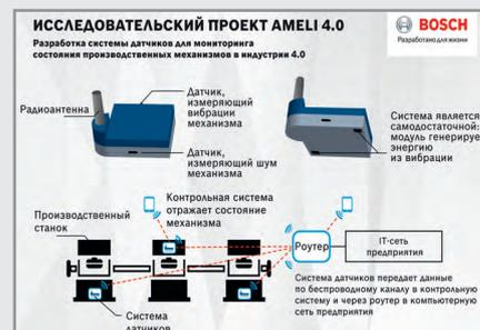
ки, износа или разрыва – предпринимает соответствующие действия. В будущем система датчиков будет способна определить потребность устройства в техническом обслуживании или ремонте. В более сложных системах данная умная проверка может обеспечиваться с помощью роутера, на который сенсоры передают собранную ими информацию, и компьютерной сети предприятия.
