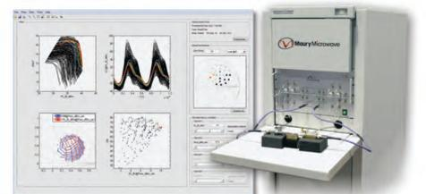
**Гармонический Load Pull в режиме импульсного смещения для устройств GaN и WBG**
