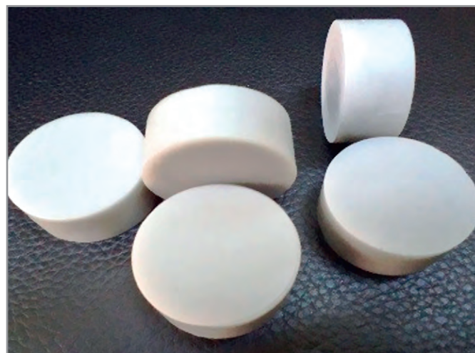
Рис. 2. Прессованные диски из AlN-гранулята
