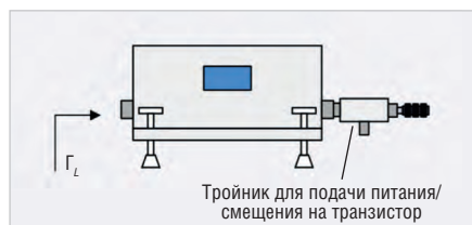
Рис. 3. Выходная цепь базовой пассивной load-pull-установки
