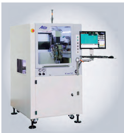
Рис. 3. Установка селективного нанесения Anda iCoat-X5
