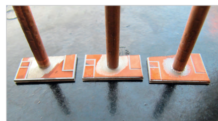
Рис. 9. Фото фрагментов плат силовых модулей с припаянными стержнями для измерения адгезии методом прямого отрыва
