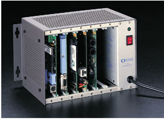
Рис. 9. Монтажный каркас для плат Micro PC
