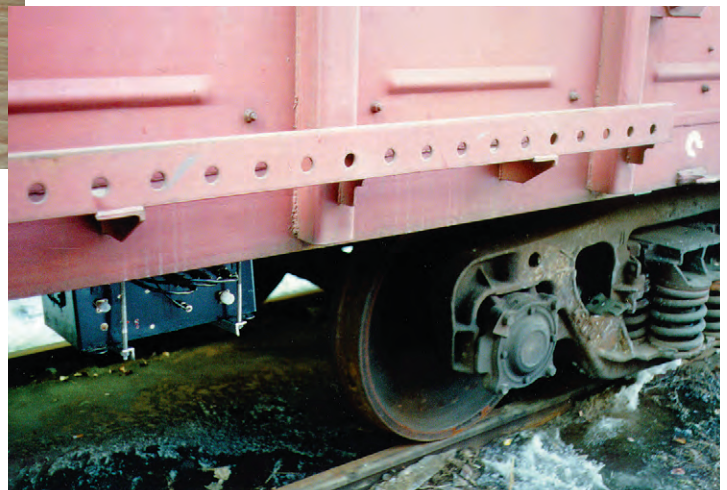
Рис. 4. Телеизмерительная станция, установленная под вагоном
