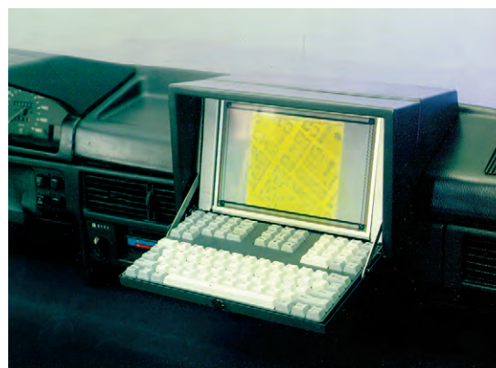
Рис. 5. Размещение бортовой ЭВМ в автомобиле
