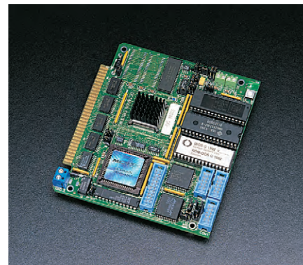
Рис. 7. Процессорная плата из семейства MicroPC фирмы Octagon Systems
