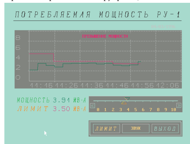
Рис. 4. График потребляемой мощности и лимита мощности
