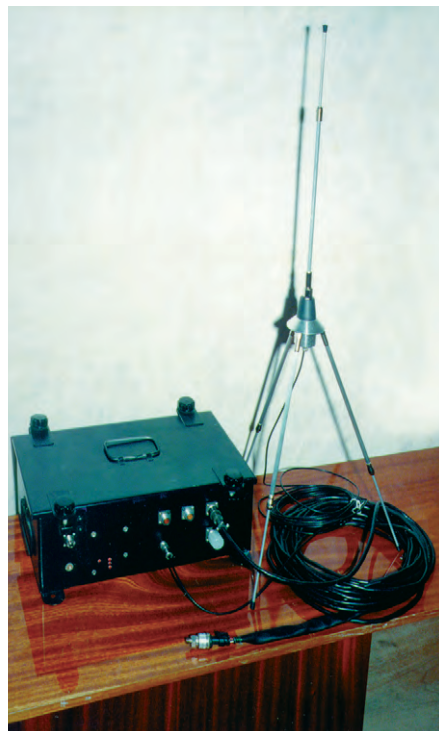
Рис. 3. Телеизмерительная станция перед установкой в вагон
