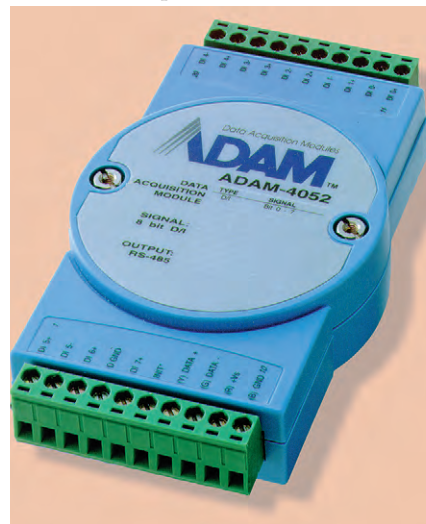
Рис. 10. Модуль серии ADAM-4000 фирмы Advantech
