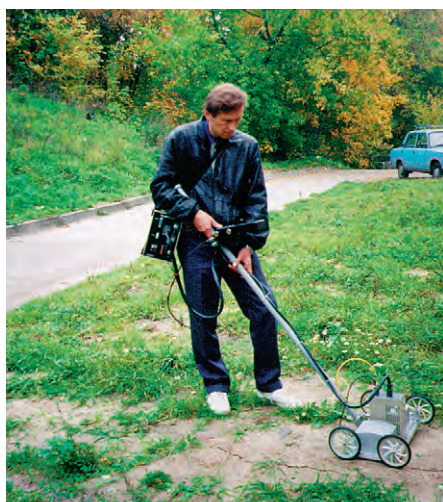
Рис. 3. Работа с георадаром на малых глубинах
