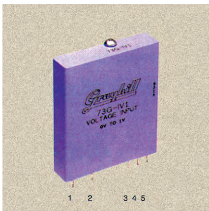
Рис. 5. Аналоговый модуль YCO фирмы Grayhill
