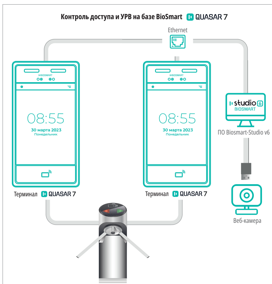
Рис. 4. Учёт рабочего времени с помощью терминалов BioSmart Quasar 7 и программного обеспечения Biosmart-Studio v6
