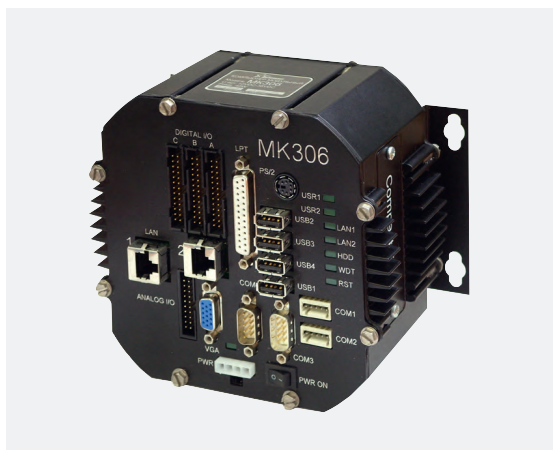
Рис. 1. МК306 – модульный компьютер для АСУ ТП
