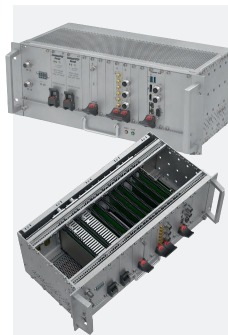
Рис. 5. Компьютер U3550, устанавливаемый на транспортном средстве
