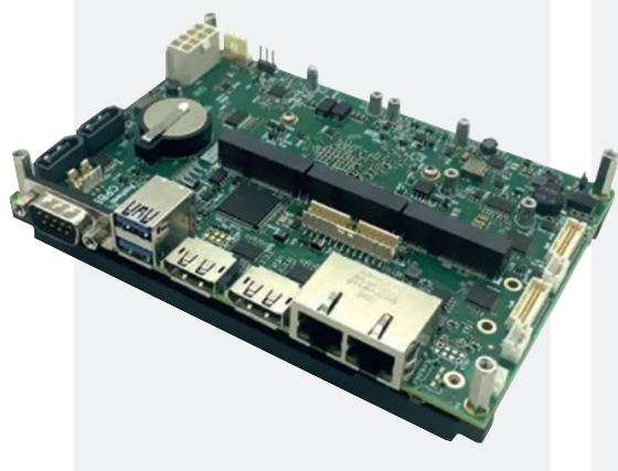
Рис. 12. Процессорная плата FASTWEL CPB910 стандарта 3,5"
