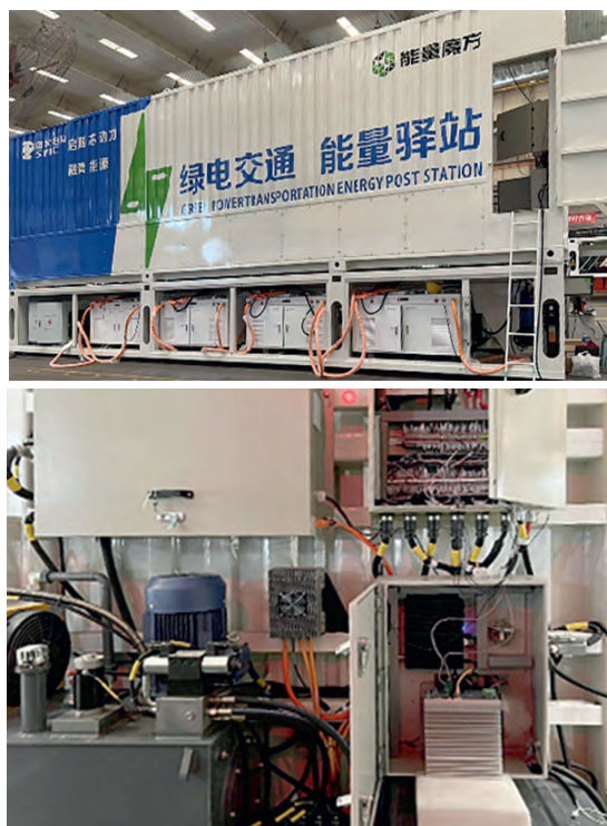
Рис. 18. Мобильная система зарядки электромобилей
