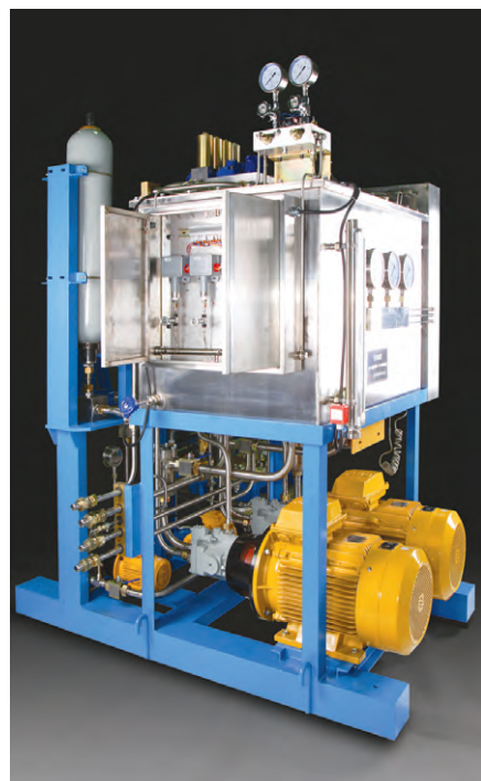
Рис. 6. Общий вид гидравлической системы высокого давления
