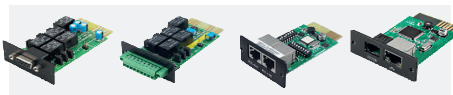
Рис. 8. Платы расширения для ИБП Systeme Electric
