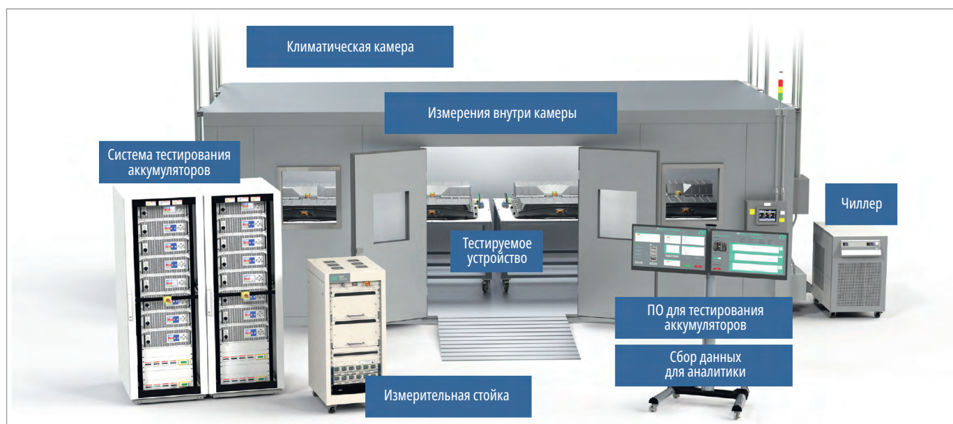
Рис. 2. Пример типовой лабораторной установки для проверки аккумуляторных батарей
