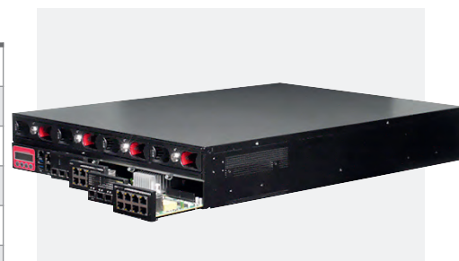
Рис. 3. Модули расширения NIM
