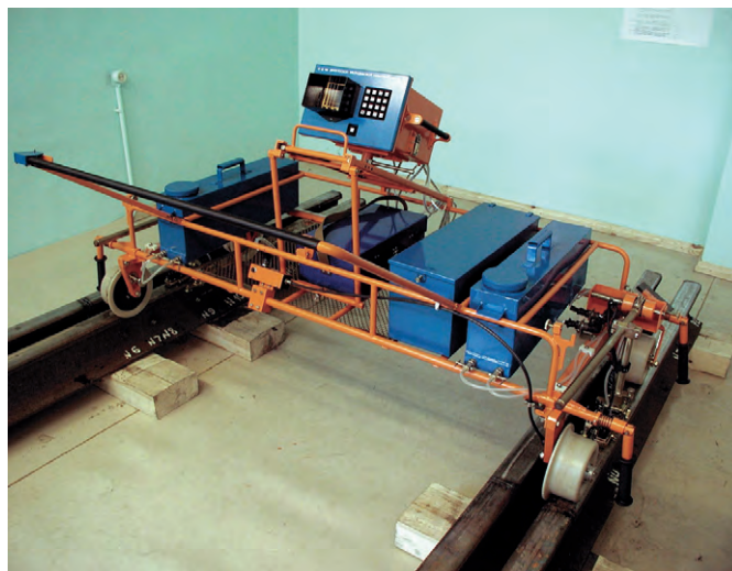
Рис. 5. Дефектоскоп с установленным на экран дисплея тубусом в сборочном цехе завода
