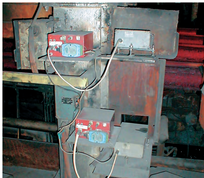
Рис. 4. Оптические измерители «РАСТР» на четырёхручьева МНЛЗ
