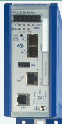
Рис. 6. Промышленный межсетевой экран Hirschmann Eagle Tofino с программным модулем обеспечения безопасности Tofino OPC Enforcer
