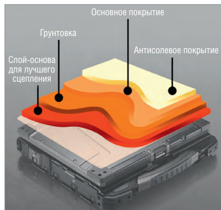
Рис. 6. Структура защитного покрытия корпуса ноутбука
