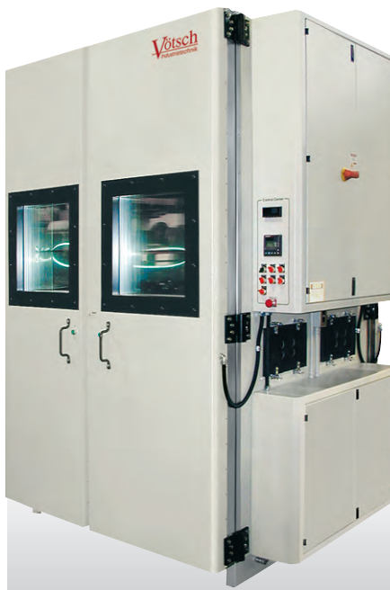
Рис. 4. Камера тестирования изделий по методологии HALT
