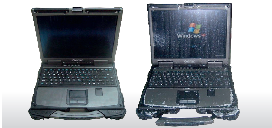
Рис. 7. Наглядная иллюстрация работы технологии антикоррозийной защиты: деталь с покрытием (а) и без него (б) после обработки солью
