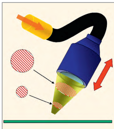
Рис. 1. Управление положением оптики позволяет регулировать точку наведения конического пучка лазерного излучения
