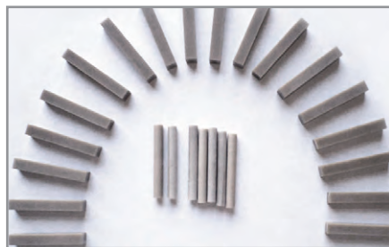
Рис. 1. Объёмные изделия из алюмонитридного гранулята
