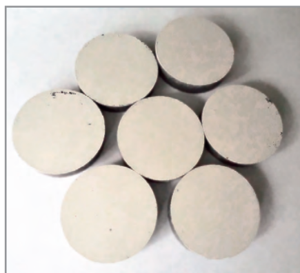
Рис. 3. Изделия из пресс-порошка нитрида алюминия, полученного на распылительном сушиле
