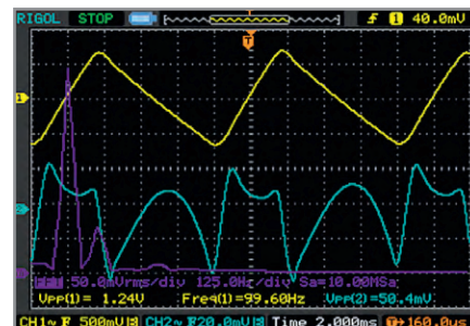
Рис. 11. Осциллограммы входного и выходного напряжения фильтра положительного напряжения при токе 8,6 А
