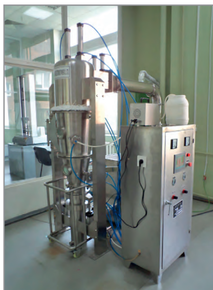
Рис. 2. Распылительное сушило для получения пресс-порошка нитрида алюминия
