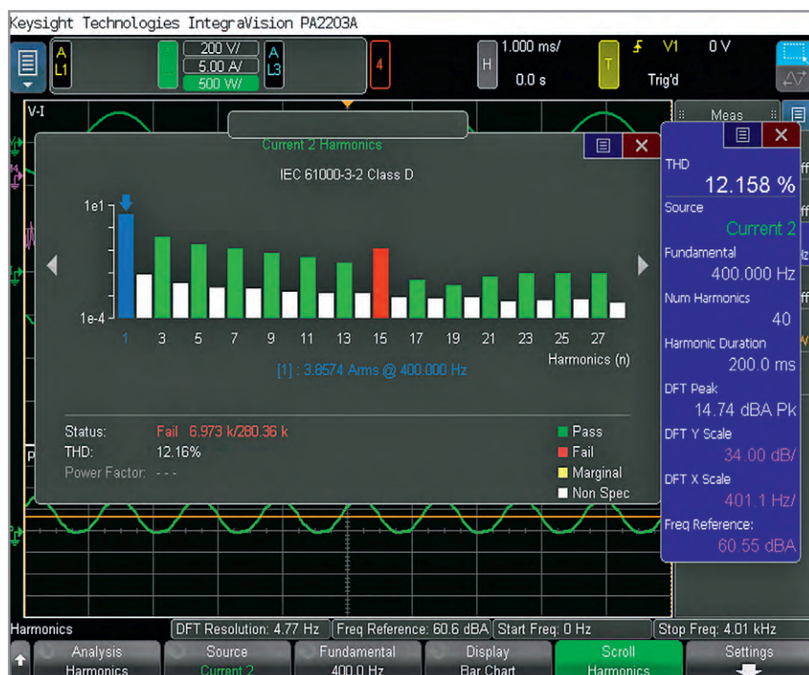
Рис. 4. Пример измерения гармоник, показывающий, что 15-я гармоника слишком велика и не укладывается в требования стандартов к качеству сетей питания
