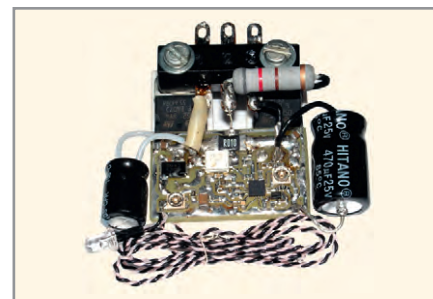
Рис. 16. Фотография фильтра и стабилизатора положительного напряжения
