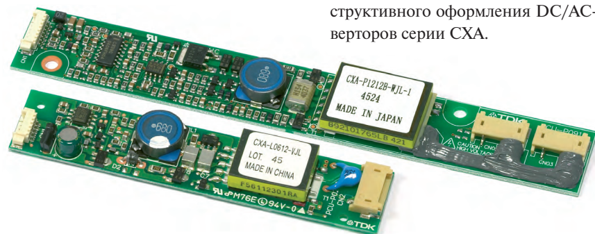
Рис. 3. Внешний вид конструкции DC/AC-инверторов, предназначенных для управления лампами задней подсветки ЖК-панелей
