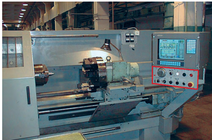
Рис. 4. Пример неэффективной модернизации: из-за несогласованных действий различных аспектов эксплуатации одинаковые станки имеют разные органы управления
