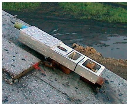
Рис. 5. Стационарный балансирный датчик динамометрирования
