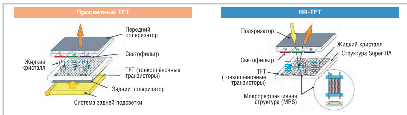
Рис. 3. Сравнение структур просветного TFT и отражательного HR-TFT ЖК-дисплеев
