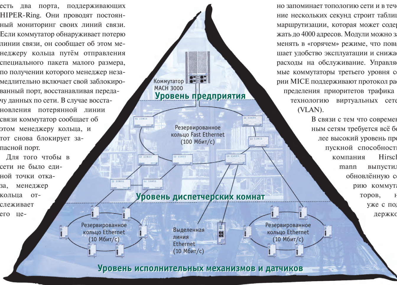
Рис. 1. Пример организации сетевой инфраструктуры предприятия с использованием технологии HIPER-Ring
