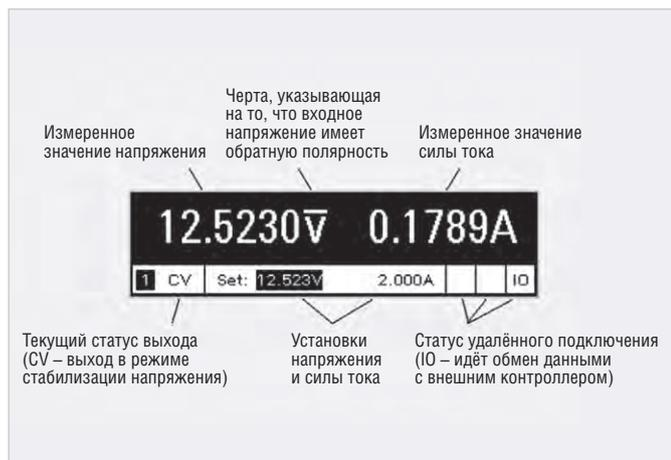
Рис. 2. Пример отображения рабочего состояния на передней панели: CV (режим стабилизации напряжения), CC (режим стабилизации тока), OV (перенапряжение) и OC (чрезмерный ток)
