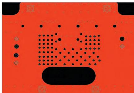
Рис. 8. Внутренний слой печатной платы до оптимизации
