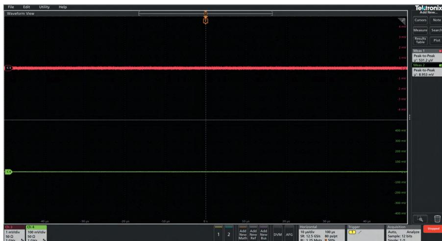
**Рис. 5.** Влияние чувствительности на измеренный случайный шум. В обоих каналах входной сигнал отсутствует. Канал 3 при чувствительности 1 мВ/дел. показывает двойной размах шума 521,2 мкВ, тогда как канал 4 при чувствительности 100 мВ/дел. показывает двойной размах шума 8,953 мВ. Это примерно в 17 раз больше шума в канале 3. Заметьте, что 8,953 мВ в канале 4 не превышают 1% от полной шкалы
