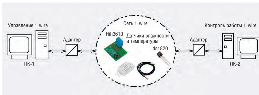
Рис. 4. Блок-схема сети 1-wire с двумя компьютерами
