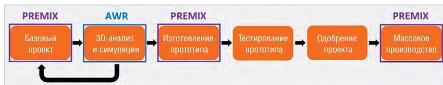
Рис. 1. Структура процесса проектирования антенны в программном обеспечении NI AWR и создания прототипа на основе Premix PREPERM
