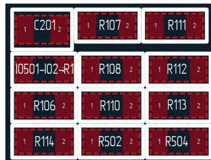
Рис. 5. Результат размещения компонентов в области
