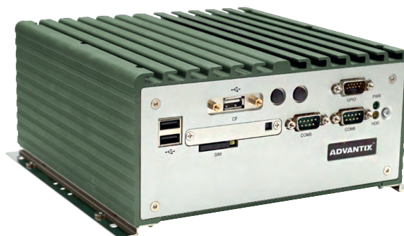
Рис. 2. ER-5000 – расширяемый безвентиляторный компьютер для работы в необслуживаемых помещениях
