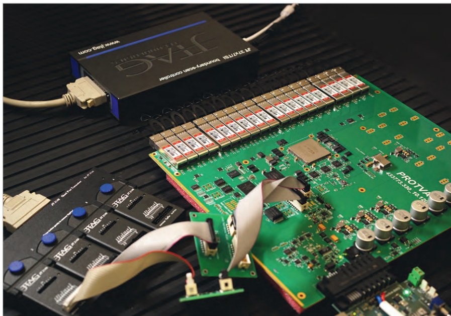
Рис. 1. Тестирование платы Protva с использованием оптических «заглушек» (loopback)
