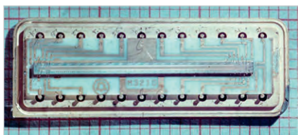
Рис. 9. Линейный сканер, использующийся в сканерах и спутниках для сканирования Земли в Google Maps
