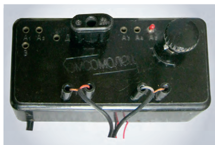
Рис. 10. Модернизированный радиоприёмник «Комсомолец» на DSP-тюнере КТ0922 в FM-диапазоне принимает станции в стерео-режиме
