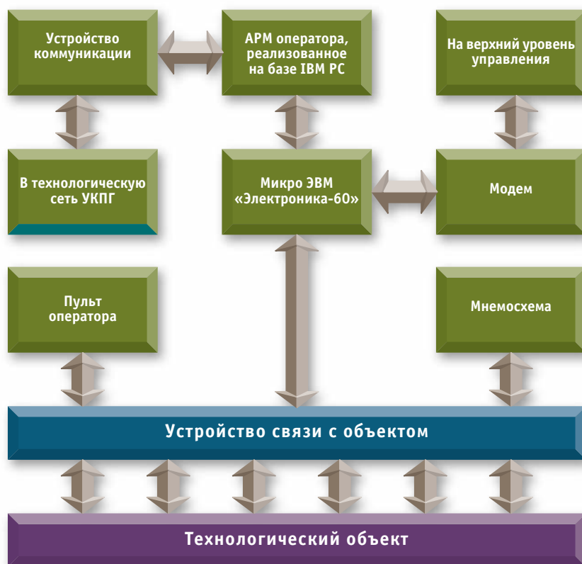
Рис. 1. Структурная схема АСУ ТП установки комплексной подготовки газа
