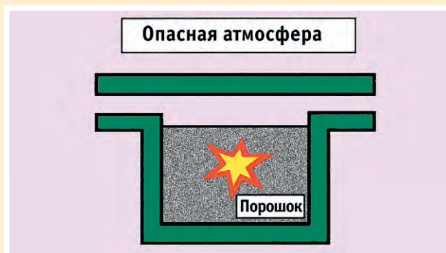
Рис. 7. Метод защиты заполнением порошком
