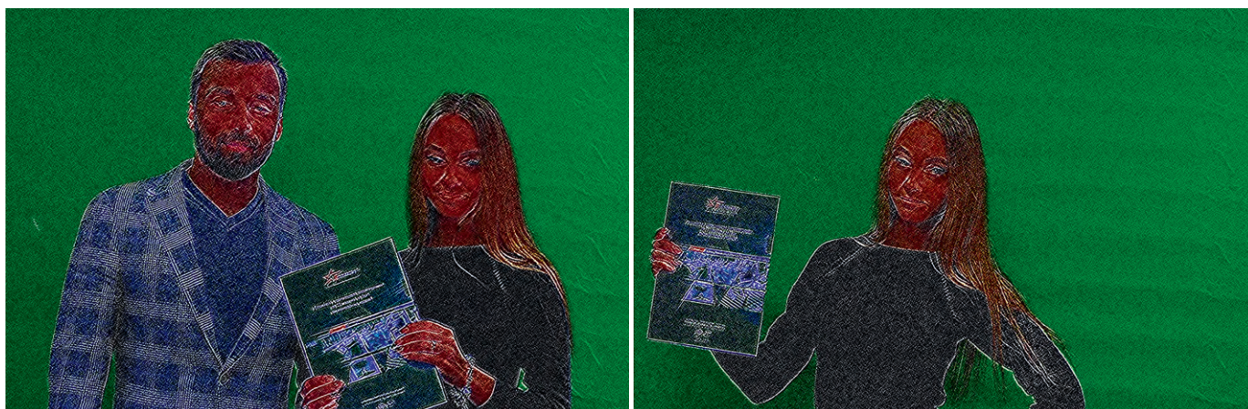
Рис. 4. Фильтрация Собеля, пример транслируемого видеопотока
