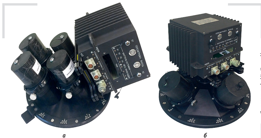
Рис. 5. Научный аппарат «Терминатор»: а – комплект для регистрации СО; б – комплект для регистрации эмиссионного слоя в окрестности солнечного терминатора
