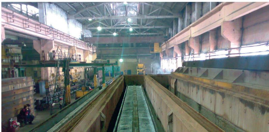
Рис. 2. Пропарочная камера (крышка снята, изделия загружены)
