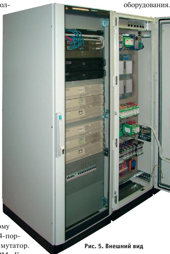
Рис. 5. Внешний вид серверного и центрального щитов
