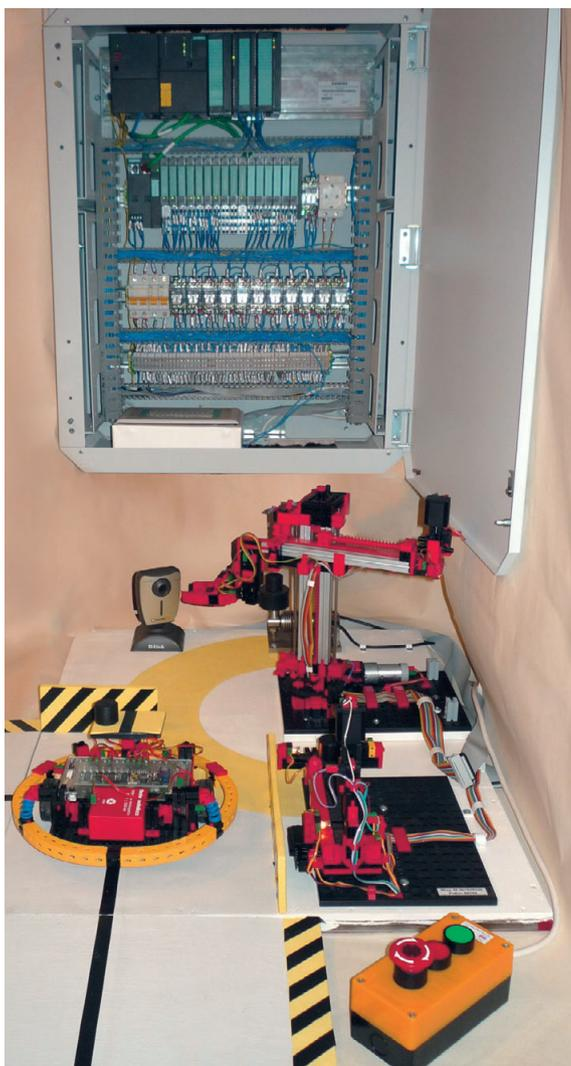
Рис. 10. Модель роботизированного технологического комплекса на основе контроллера SIMATIC S7-315F
