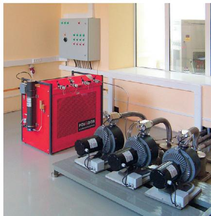
Рис. 4. Пульт силовой, компрессор и вакуумные насосы установки калибровки
