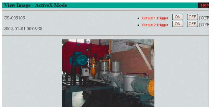
Рис. 5. Встроенный Web-интерфейс IP-видеокамеры
