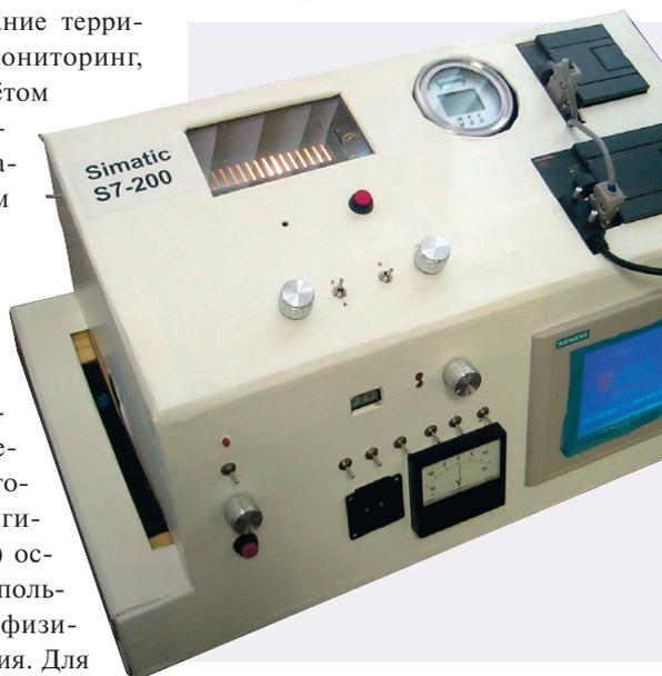
Рис. 9. Лабораторный стенд управления дискретным и непрерывным технологическими процессами на базе контроллера SIMATIC S7-224XP
