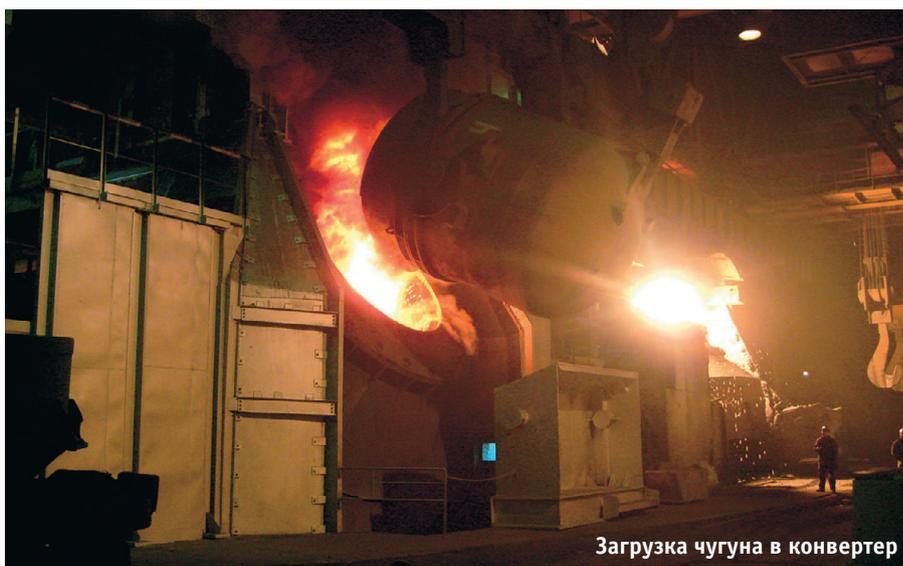
Загрузка чугуна в конвертер
