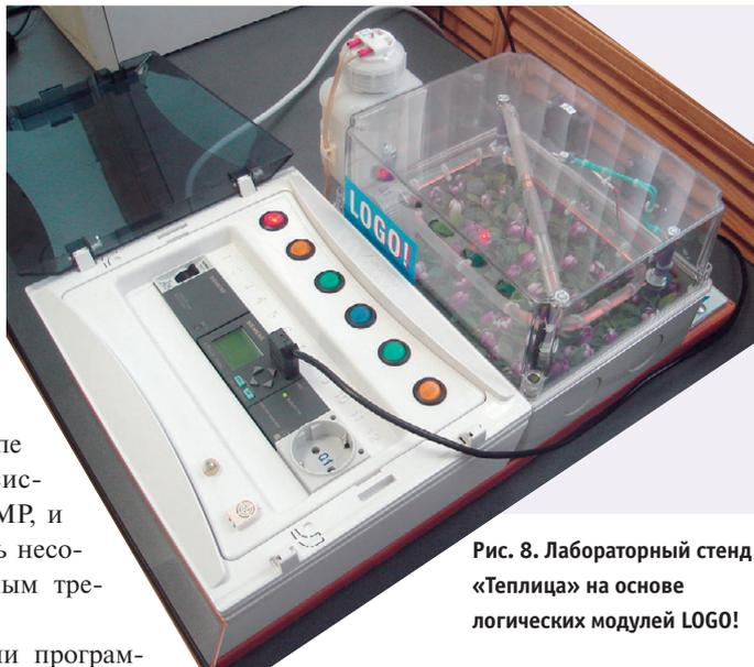
Рис. 8. Лабораторный стенд «Теплица» на основе логических модулей LOGO!
