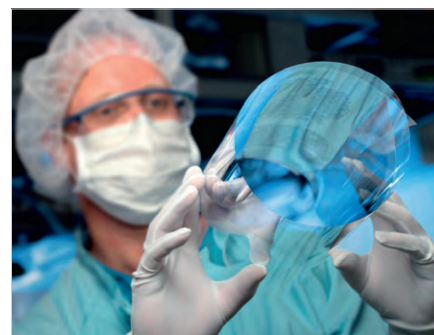
Рис. 5. Ультратонкое гибкое стекло, изготовленное с помощью непрерывной вытяжки
