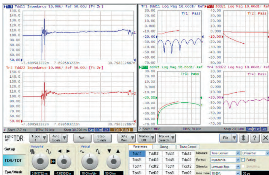
Рис. 2. Одновременные измерения во временной и частотной областях
