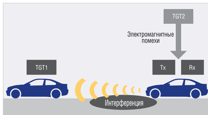
Рис. 10. Анализ тракта распространения радиоволн с помощью САПР SystemVue и EMPPro
