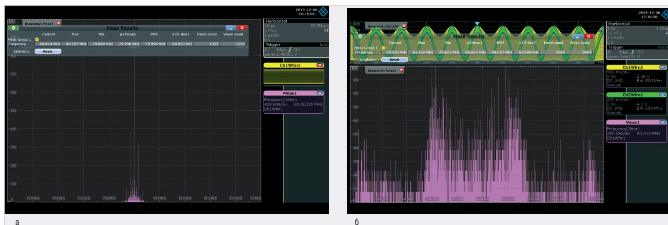
Рис. 8. Распределение импульсов по частоте: а) режим 1 – в отсутствие управляемого джиттера; б) режим 2 – при наличии управляемого джиттера
