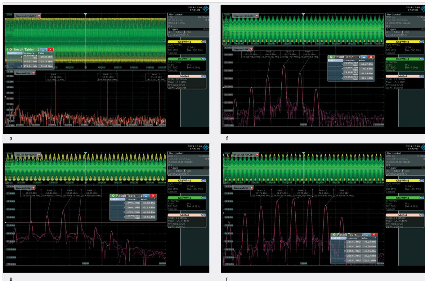
Рис. 9. Спектрограммы, полученные с использованием функции БПФ осциллографа R&S RTO2044: а) в режиме 1 для всех гармоник; б) в режиме 2 для первой гармоники; в) в режиме 2 для второй гармоники; г) в режиме 2 для третьей гармоники
