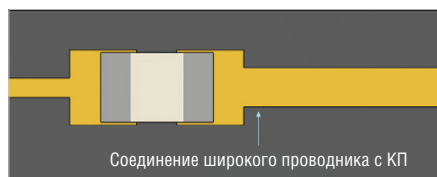
Рис. 6. Подключение широкого проводника к силовой контактной площадке
