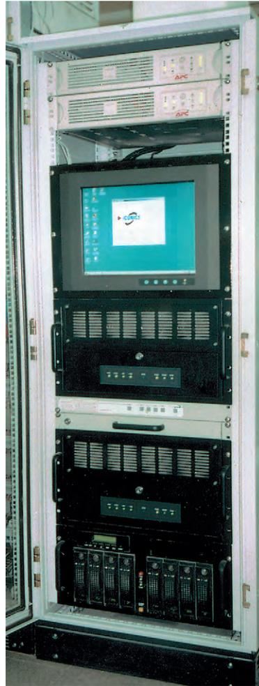
Рис. 6. Шкаф с двумя серверами и массивом дисковых накопителей
