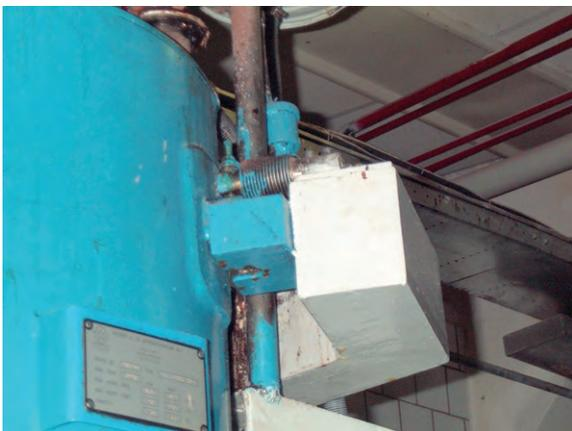
Рис. 9. Расположение тензодатчика весовой станции
