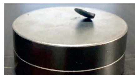
Рис. 2. Демонстрация «левитации» в качестве доказательства эффекта Мейснера в компаунде LK-99
