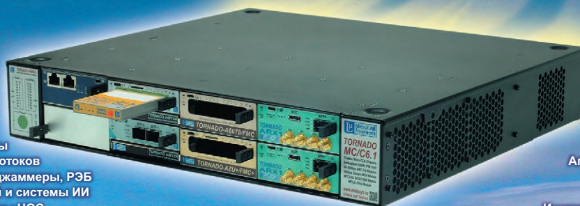
TORNADO-MC/C6.1 Шасси MicroTCA с 6-ю AMC модулями и источником питания 650Вт
