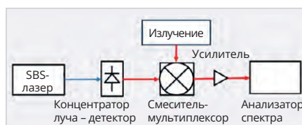
Рис. 12. Блок-схема лазерной установки при исследованиях в области фотоники
