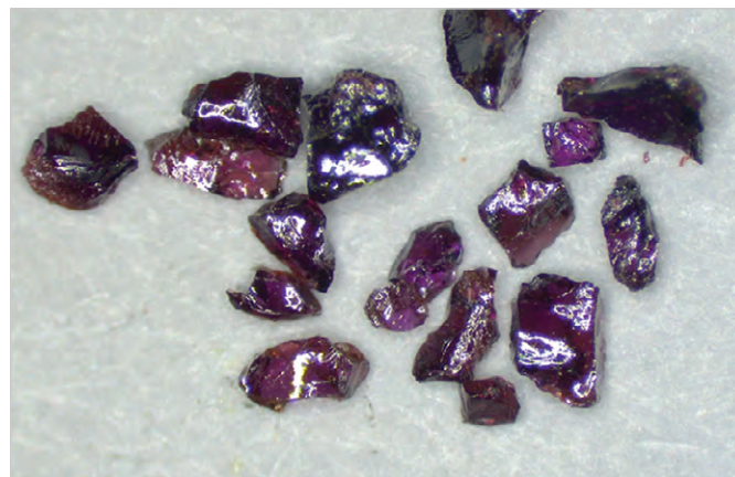
Рис. 6. Использование технологии «плавающей зоны» (floating zone) позволило получить химически чистые по всему объёму образцы: оптически прозрачные монокристаллы LK-99 [24]
