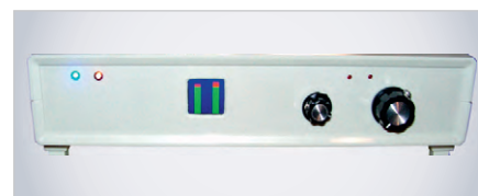
Рис. 5. Внешний вид работающего усилителя с индикатором уровней звука
