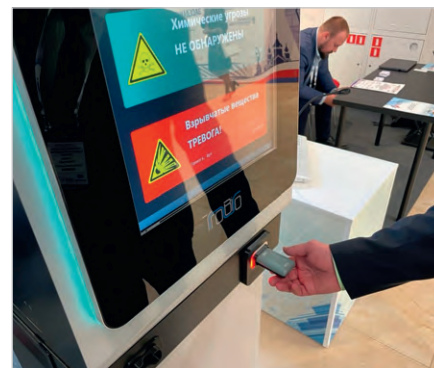
Рис. 16. Анализ материала в контейнере с помощью стационарного спектроанализатора
