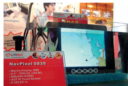
Рис. 5. Дисплей NPD0835, погруженный в воду, продолжает работать
