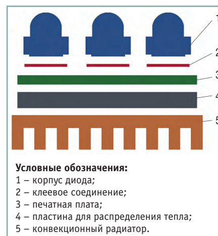
Рис. 3. Схема монтажа элементов светодиодной подсветки
