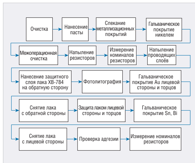
Рис. 2. Технологическая схема комбинированного метода изготовления плат
