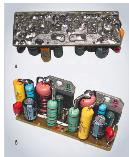
Рис. 10. Плата одного канала (В) мостового усилителя мощности: а) вид со стороны дорожек; б) вид с обратной стороны
