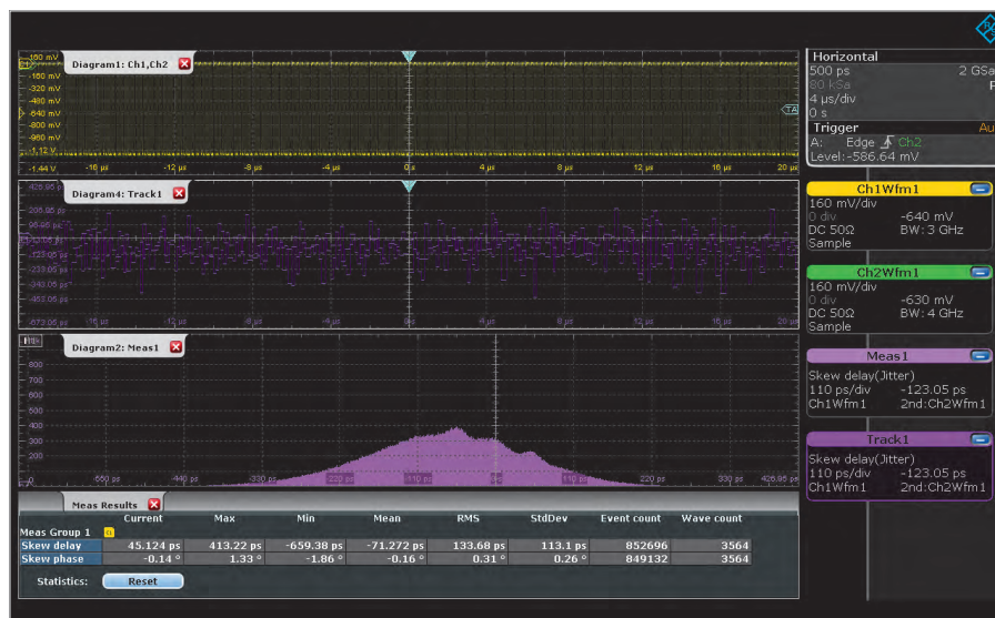
Рис. 9. Результат измерений характеристик джиттера временной задержки зависимых цифровых сигналов
