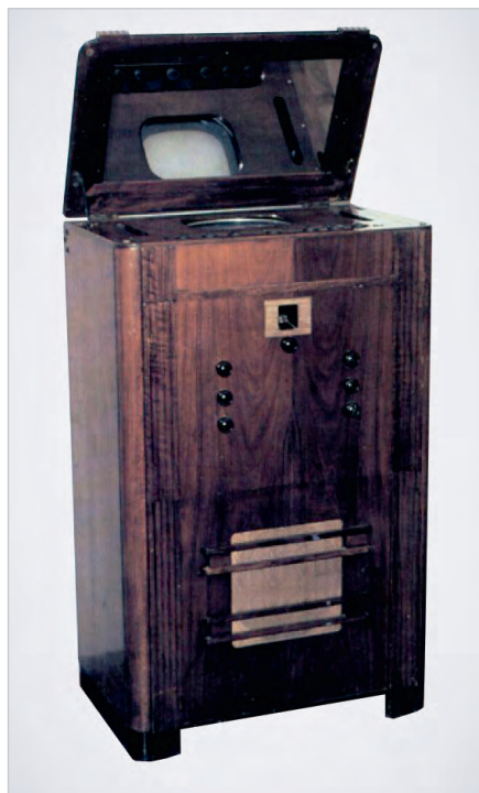
Первый отечественный серийный электронный телевизор ТК-1
