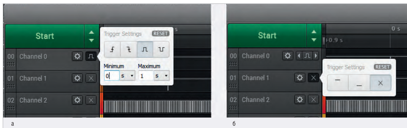
Рис. 13. Задание триггера для канала: а) контекстное меню для задания триггера; б) задание уровня сигнала для срабатывания триггера
