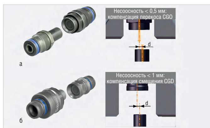
Рис. 5. Соединители для «врубных» соединений (внешний вид и принцип работы): а) соединитель серии CGO с компенсацией перекося; б) соединитель серии CGD с компенсацией радиальных смещений
