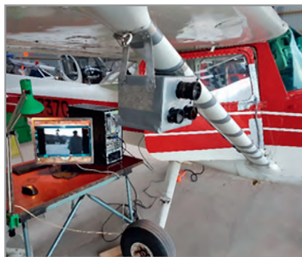
Рис. 3. Крепление и установка МСУВ RT-700Combo на борт двухместного самолёта Cessna для испытаний: слева – отладка перед полётом; справа – вид МСУВ сзади (верхний провод – коаксиальный кабель для передачи видео и навигационных данных, средний – антенна GPS/ГЛОНАСС, нижний – питание 24 В)
