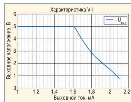
Рис. 1. Зависимость выходного напряжения от выходного тока при коротком замыкании нагрузки для преобразователя ARE10015D
