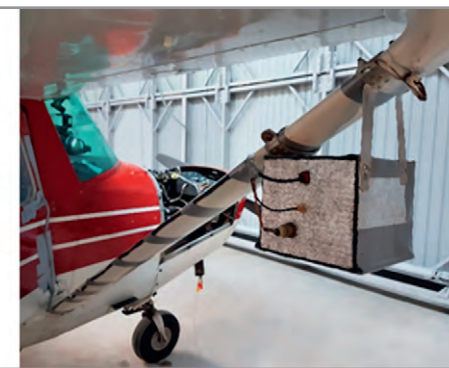
Рис. 3. Крепление и установка МСУВ RT-700Combo на борт двухместного самолёта Cessna для испытаний: слева – отладка перед полётом; справа – вид МСУВ сзади (верхний провод – коаксиальный кабель для передачи видео и навигационных данных, средний – антенна GPS/ГЛОНАСС, нижний – питание 24 В)
