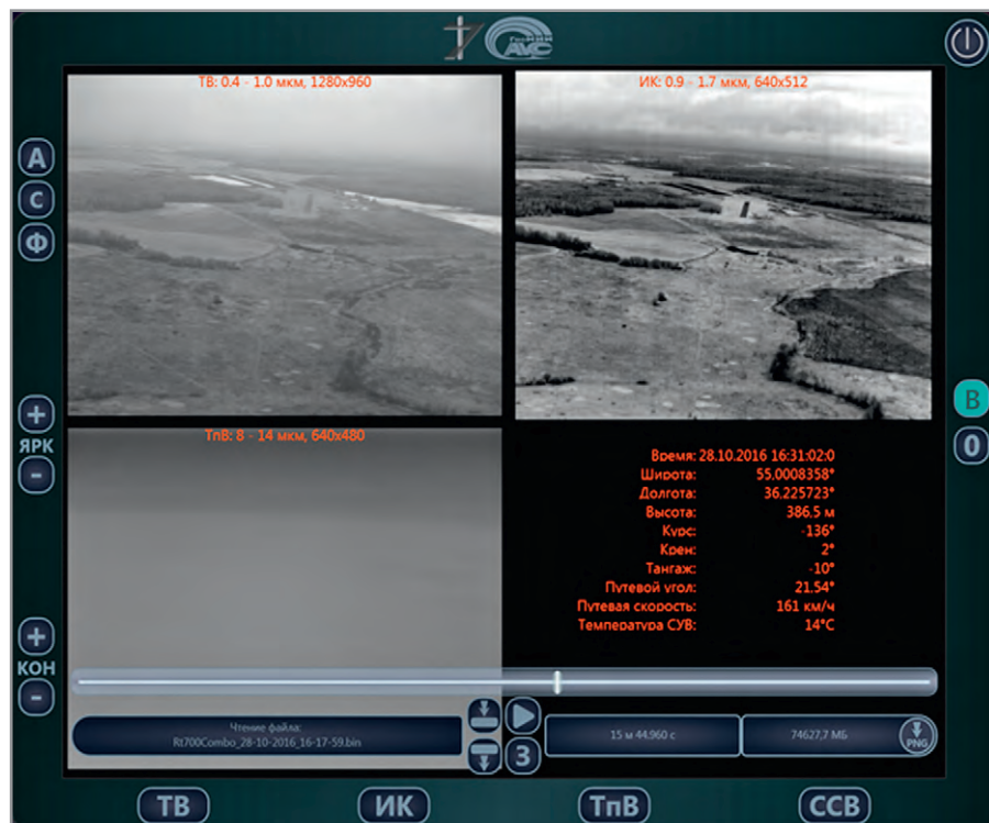
Рис. 7. Интерфейс «мультиспектрального видеорегистратора» ПО МСУВ RT-700Combo, пример реальных изображений при заходе самолёта на посадку
