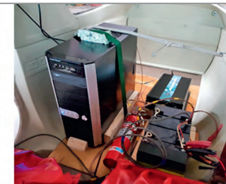
Рис. 4. Крепление и установка МСУВ RT-700Combo на борт двухместного самолёта Cessna для испытаний: слева – внешний вид; справа – установка в багажном отделении
