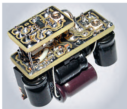
Рис. 24. Фотография стабилизатора –12,5 В с платой защиты
