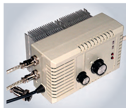
Рис. 33. Усилитель на ОУ LM3886 в сборе
