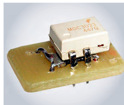
Рис. 25. Общий вид плат защиты со стороны оптрона
