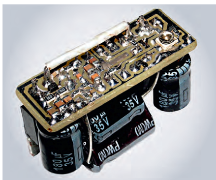
Рис. 23. Фотография стабилизатора +12,5 В без платы защиты
