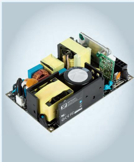
Все модели ИП ECH450 предназначены для работы в диапазоне напряжений от 90 до 264 В с понижением выходной мощности при входных напряжениях ниже 100 В. Фазный и нейтральный провода защищены предохранителями F8A/250 В.
