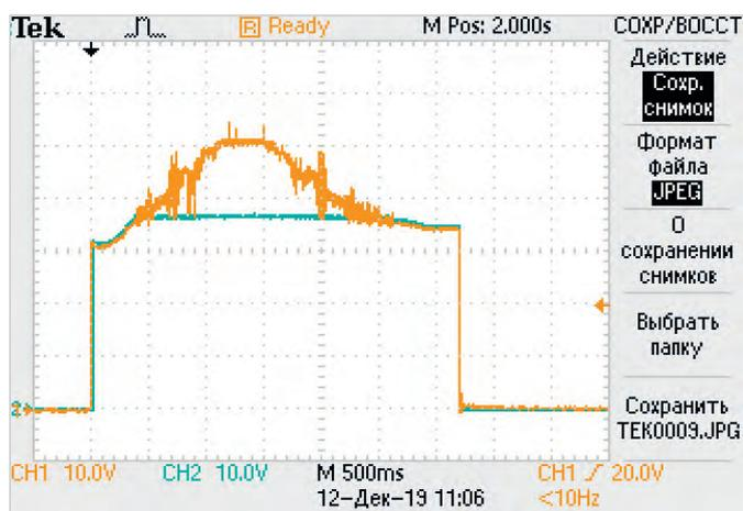
Рис. 6. Переходный процесс в бортовой СВЭП с выбросом 51 В и коммутационными помехами
