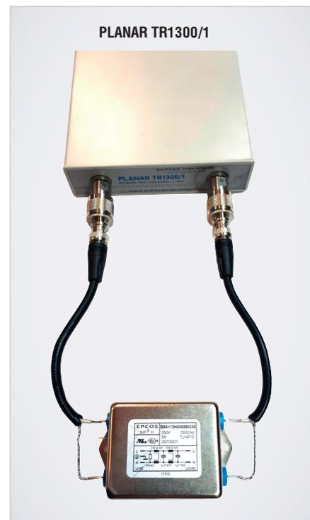
Рис. 2. Измерение затухания фильтра в дифференциальном режиме с помощью векторного анализатора цепей типа PLANAR TR1300/1, подключаемого к фильтру с помощью коаксиального кабеля типа RG58C с волновым сопротивлением 50 Ом
