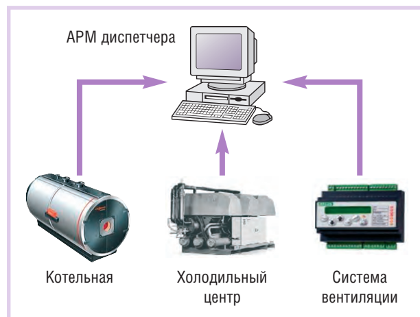
Рис. 1. Общая структура АСДУ инженерных сетей ТРК
