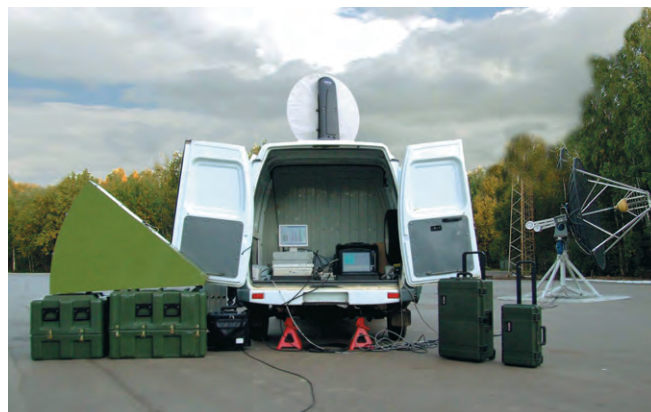
Рис. 4. Развёрнутый в полевых условиях мобильный пункт приёма телеметрической информации (справа — антенна МАС-3, в салоне автомобиля — станция МПРС и компьютер управления антенной, на переднем плане — транспортировочная тара)
