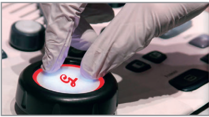
Рис. 6. MTRE от Grayhill – оптический энкодер с интегрированным мультитачпадом
