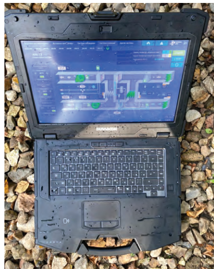
Рис. 4. Дисплей ноутбука Z14I под прямыми солнечными лучами
