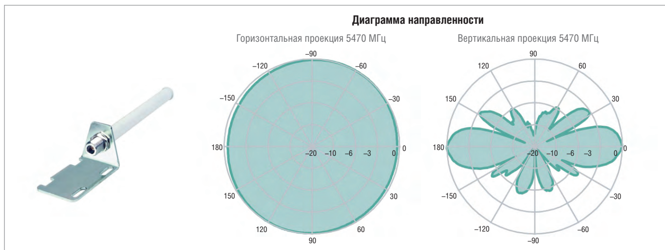
Рис. 4. Всенаправленная Wi-Fi-антенна для создания равномерного кругового покрытия до 200 м
