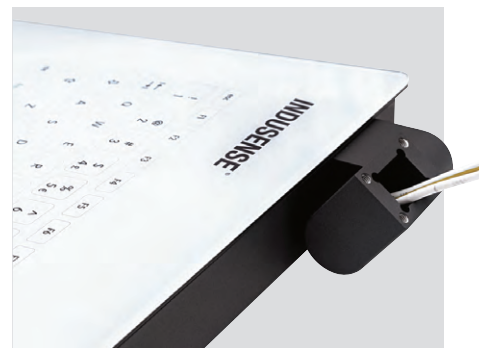
Рис. 7. Механизм складывания клавиатуры
