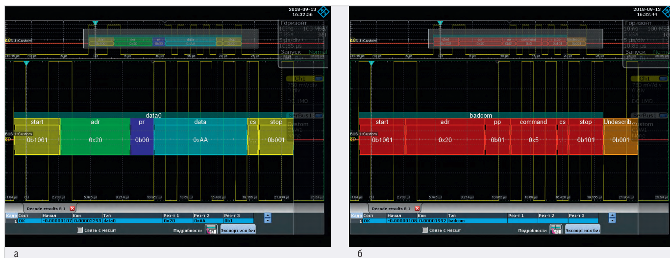
Рис. 10. Результат декодирования MC DATA0 (1 Мбит/с) в NRZ-коде при заданном значении скорости приёма: а) 929 Кбит/с; б) 928 Кбит/с
