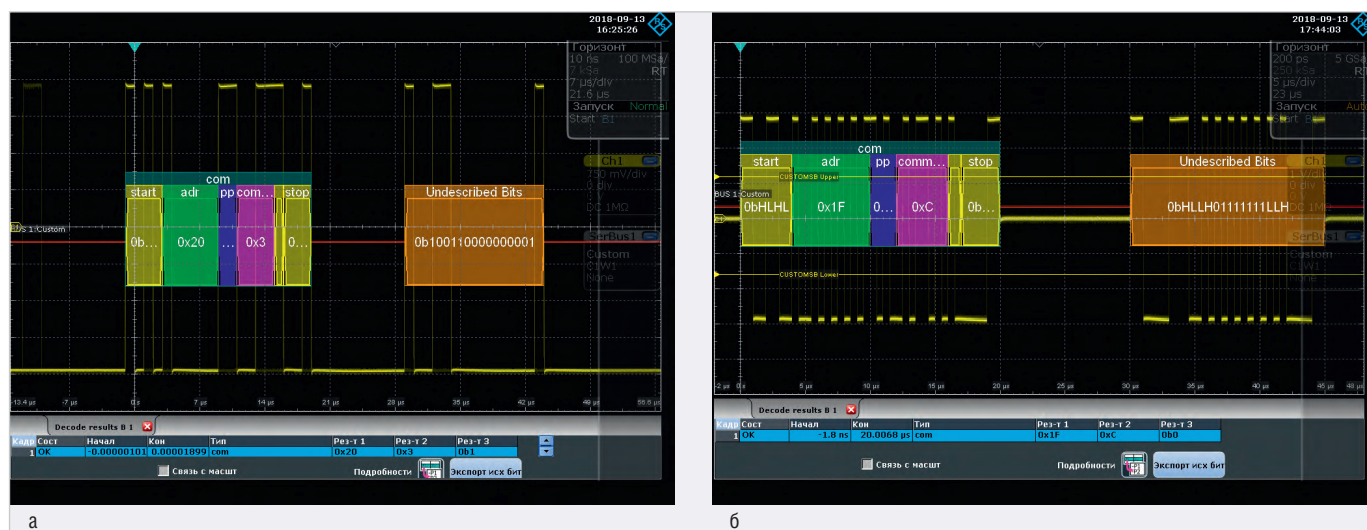
Рис. 9. Результаты декодирования машинного слова COM и слова, отсутствующего в лексиконе опции R&S RTE-K50: а) для NRZ-кода; б) для манчестерского кода
