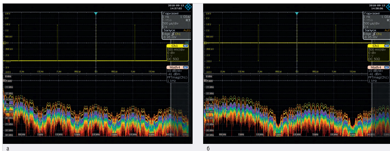
Рис. 4. Результаты построения спектра на основе быстрого преобразования Фурье: а) для NRZ-кода; б) для манчестерского кода
