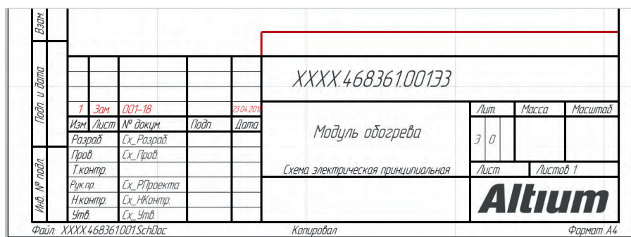
Рис. 4. Пример заполненной основной надписи листа схемы
