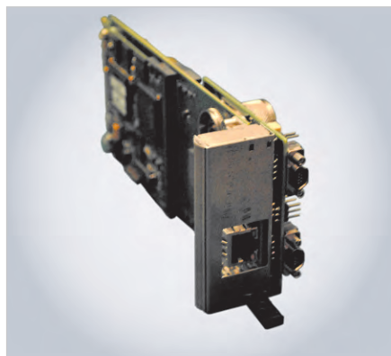
Рис. 98. Внешний вид процессорного модуля оптоэлектронного коммутатора интерфейса SpaceWire на плате форм-фактора 3U
