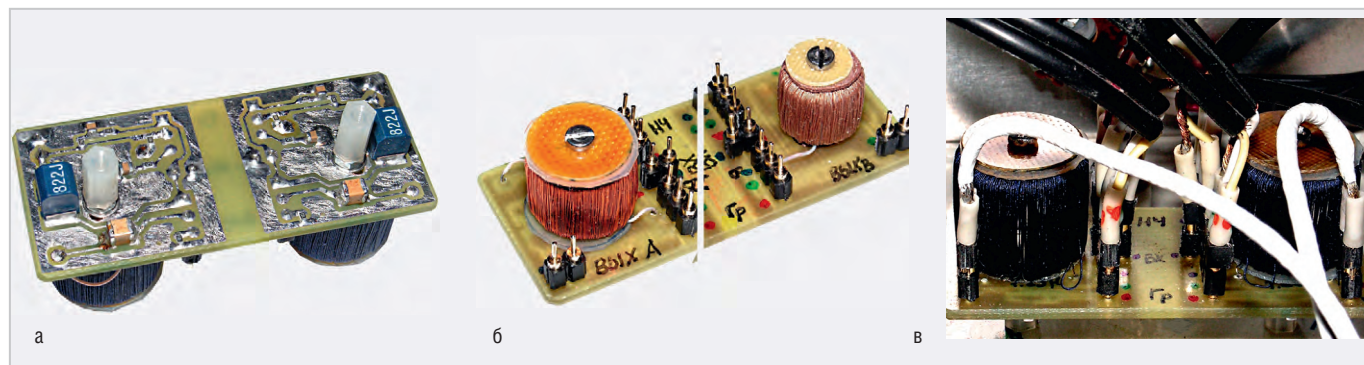
Рис. 3. Внешний вид ТКРГ: а) со стороны дорожек ( 2 \times R16 ); б) со стороны катушек (левая часть 2 \times R13 – слева, правая часть 2 \times R10 – справа); в) в составе усилителя ( 2 \times R16 )
