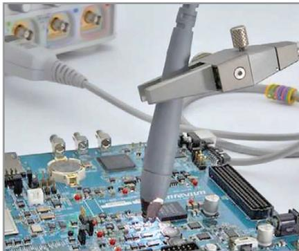
Рис. 4. Подключение осциллографа к тестируемой печатной плате через пробник с зажимом FreeHand
