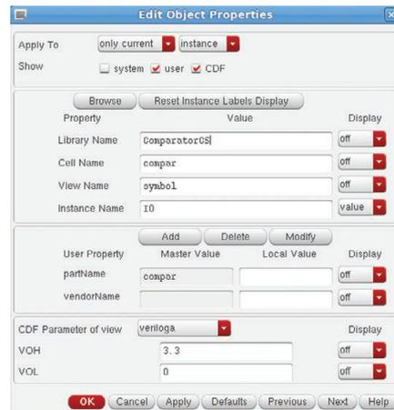
Рис. 5. Окно настроек модели компаратора в среде Cadence Virtuoso
