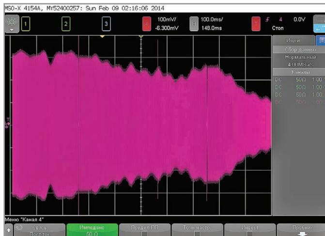
Рис. 9. Осциллограмма синусоидального сигнала с меняющейся от 0,1 до 3 ГГц частотой для аналогового канала № 4 с входом 50 Ом
