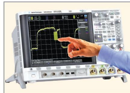
Рис. 1. Внешний вид осциллографа Agilent серии 4000X с сенсорным дисплеем
