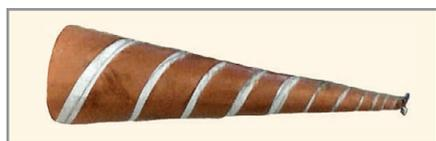
Рис. 6. Макет логоспиральной антенны
