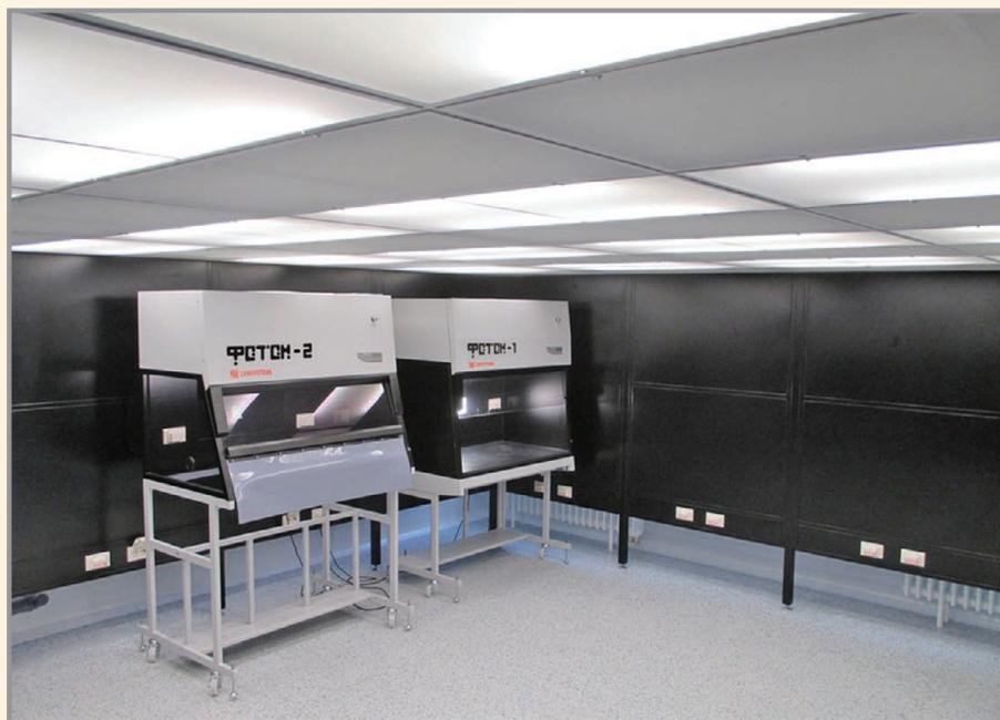
осуществления юстировки лазерных генераторов. Ограждения чистой зоны выполнены из металлических панелей, окрашенных чёрной порошковой эмалью, исключающей попадание прямого света и возникновение бликов. Внутри чистой зоны установлены ламинарные боксы «Фотон» двух видов, специально разработанные в соответствии с требованиями заказчика с учётом особенностей технологических процессов.
