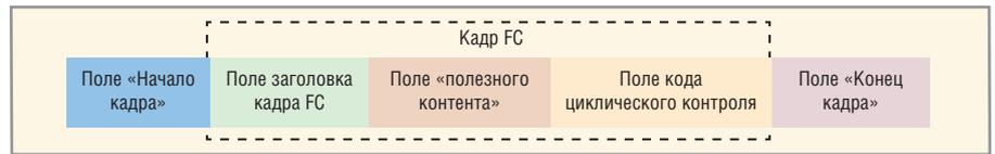
Рис. 1. Структура ADVB-кадра (оптоволоконный канал (Fibre Channel, FC)).
