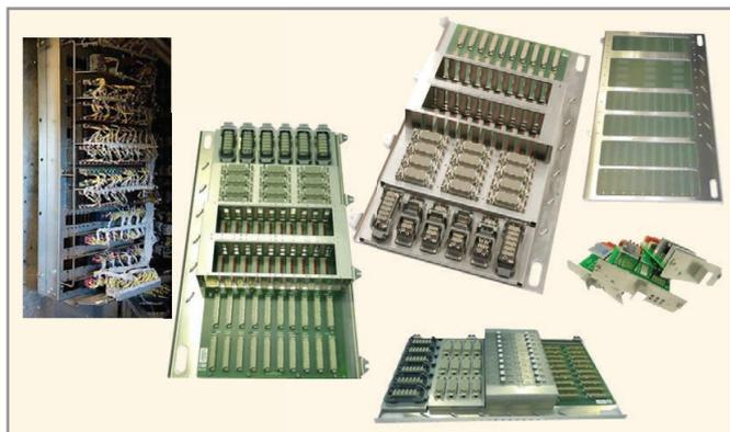
Рис. 5. Объединительная плата с разъёмами DIN 41 612 тип F и HARTING Nan, от оригинала (слева) к готовой разработке
