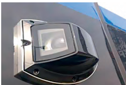
Рис. 10. Наружная установка камер в поезде дальнего следования
