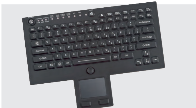
Рис. 9. Клавиатура TMLT-890-TP-OEM-USB/PS2 со встроенной сенсорной панелью
