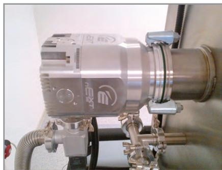
Рис. 4. Турбомолекулярный насос серии nEXT300
