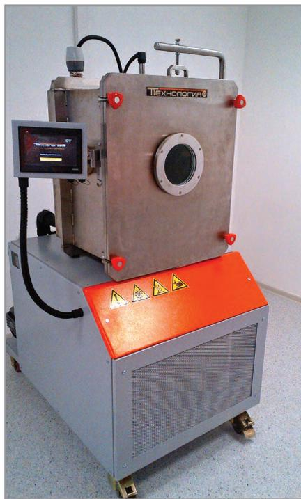
Рис. 1. Внешний вид испытательной камеры глубокого вакуума BK-125
