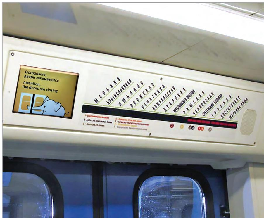
Рис. 1. Наддверное табло с монитором в Московском метрополитене
