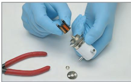
Рис. 3. Процесс замены катушки в реле Gigavac
