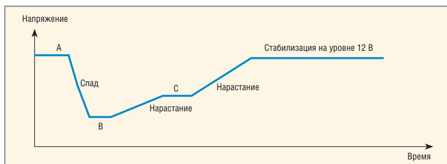
Рис. 2. Пример формы напряжения бортовой сети автомобиля
