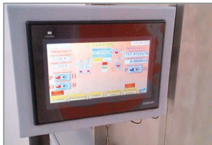
Рис. 5. Внешний вид ПЛК OMRON
