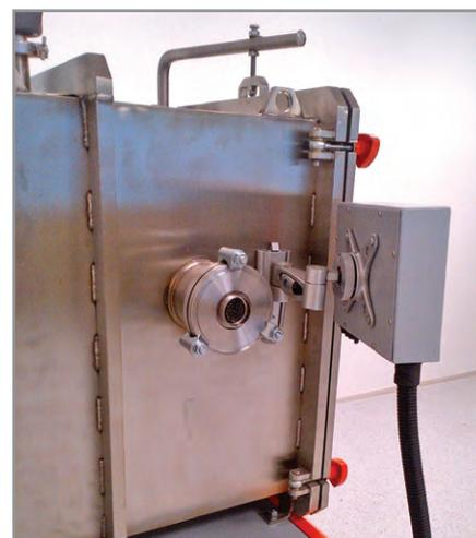
Рис. 6. Кронштейн для крепления ПЛК
