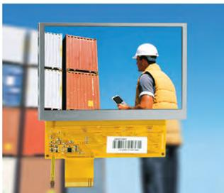
Габаритные размеры 105,5×67,2×5,05 мм, разрешение 480×272 точки. Модель LQ043T1DG01 оснащена резистивным сенсорным 4-проводным экраном. Дисплеи предназначены для применений в переносном медицинском оборудовании, ручных считывателях штрих-кодов, навигационных устройствах и контрольно измерительном оборудовании. ●
