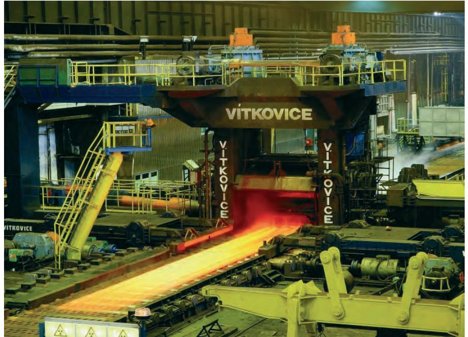
Рис. 1. Сердце прокатного стана — 3,5-метровый пресс для проката листов толщиной от 5 до 70 мм и шириной до 3,3 м
