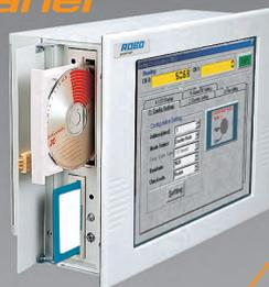
Основная конструктивная особенность панельных компьютеров iROBO Panel заключается в том, что в одном корпусе объединены промышленный компьютер и LCD-монитор. Размер компьютера по передней панели соответствует размерам стандартной LCD-панели, а толщина составляет всего 100-110 мм. Это позволяет устанавливать такой компьютер как в панель, так и в 19" стойку.
