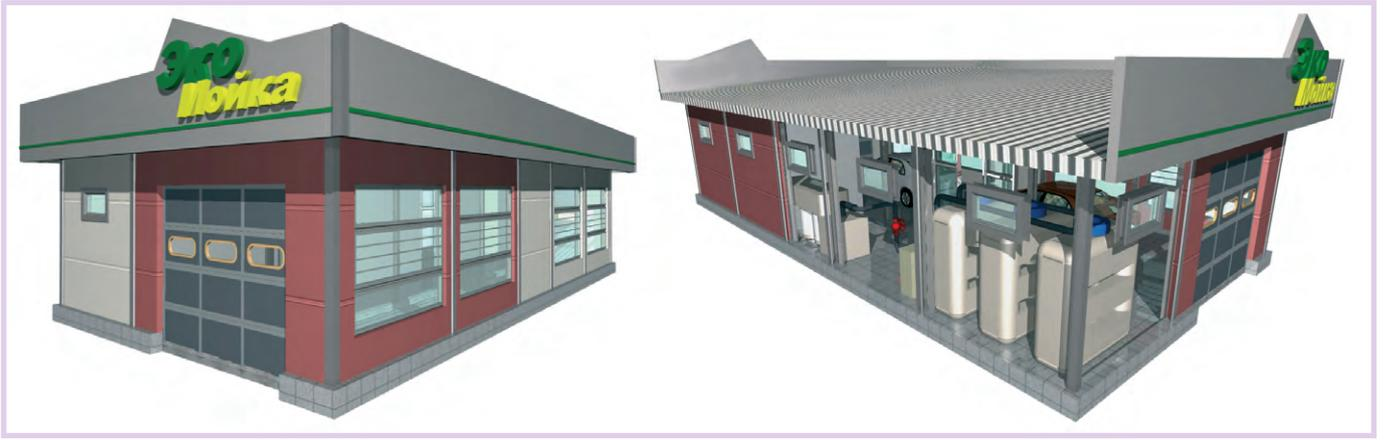
Рис. 1. Проектная проработка здания автомойки как быстровозводимого сооружения модульного типа
