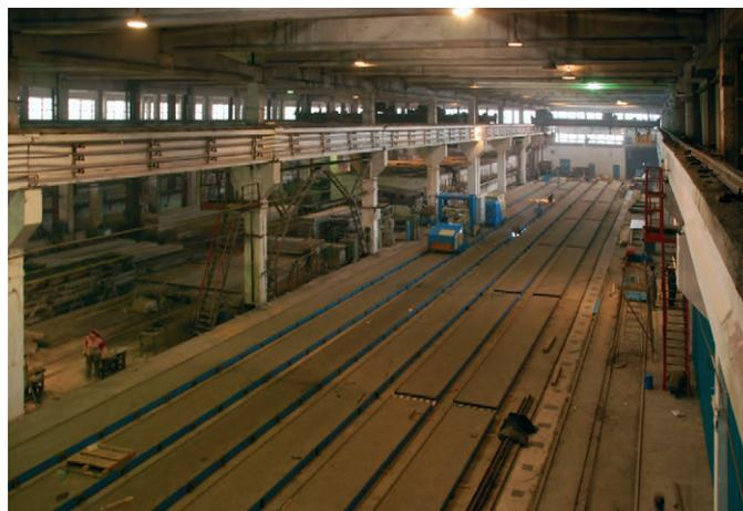
Линия по производству плит перекрытия
