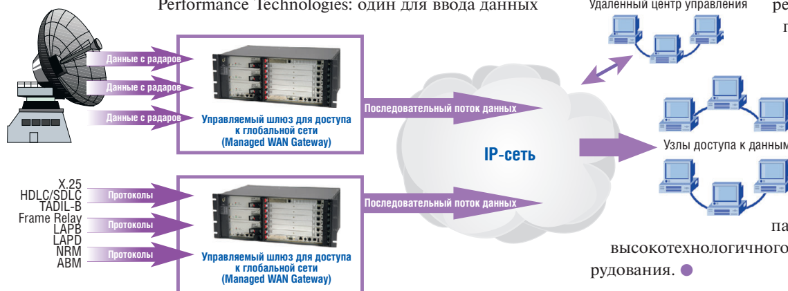
Рис. 5. Схема построения системы удалённого мониторинга состояния воздушного пространства с использованием интеллектуальных шлюзов WAN-LAN Performance Technologies
