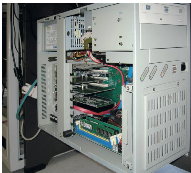
Рис. 4. Системный блок АРМ ШН (боковая крышка корпуса IPC-6608 снята для демонстрации внутренней конструкции блока)
