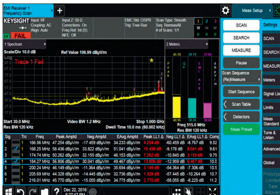
Рис. 4. Использование приложения для измерения ЭМП для анализаторов
