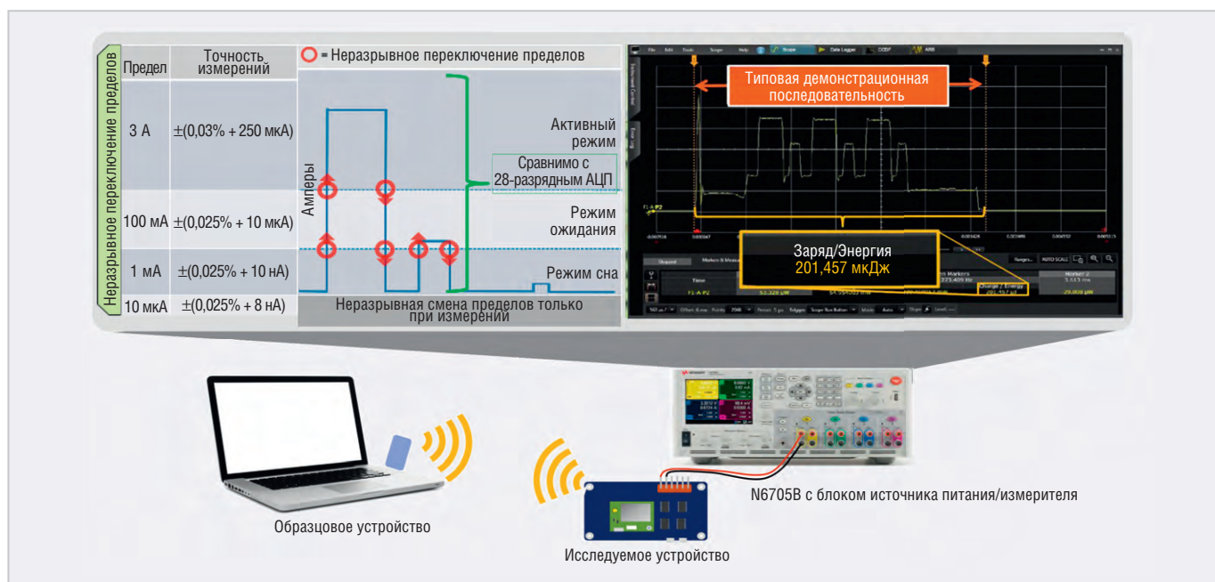
Рис. 5. Динамический анализ потребления мощности с помощью анализатора питания
