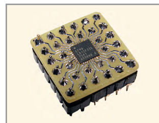
Рис. 22. Плата-переходник для микроконтроллера EFM8LB12 (разводка представлена на рисунке 18)
