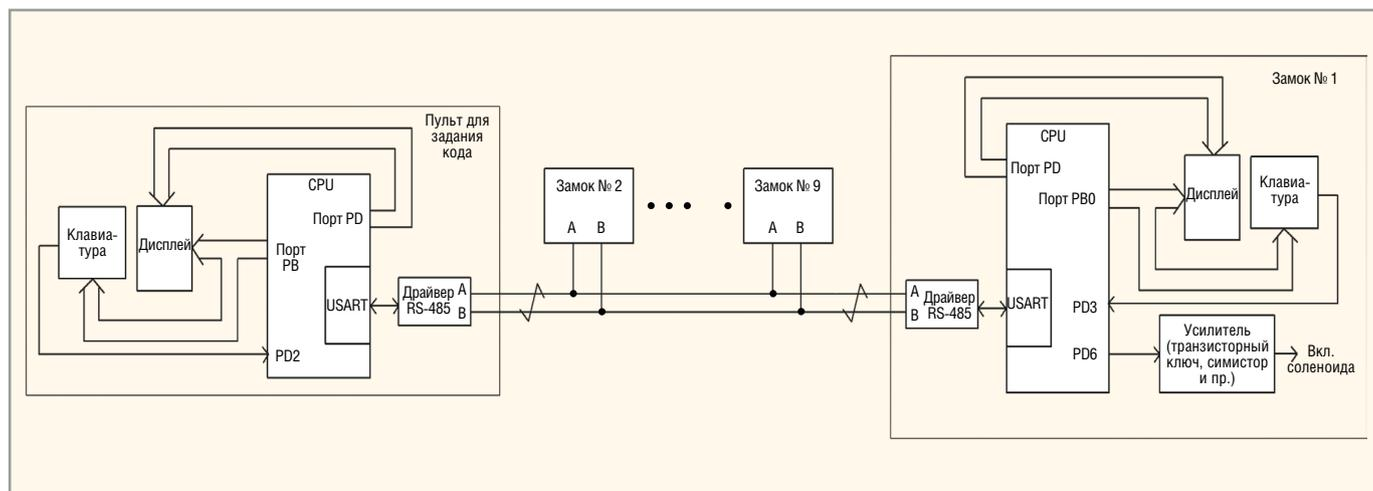
Рис. 1. Схема подключения пульта и замка к сети на основе RS-485
