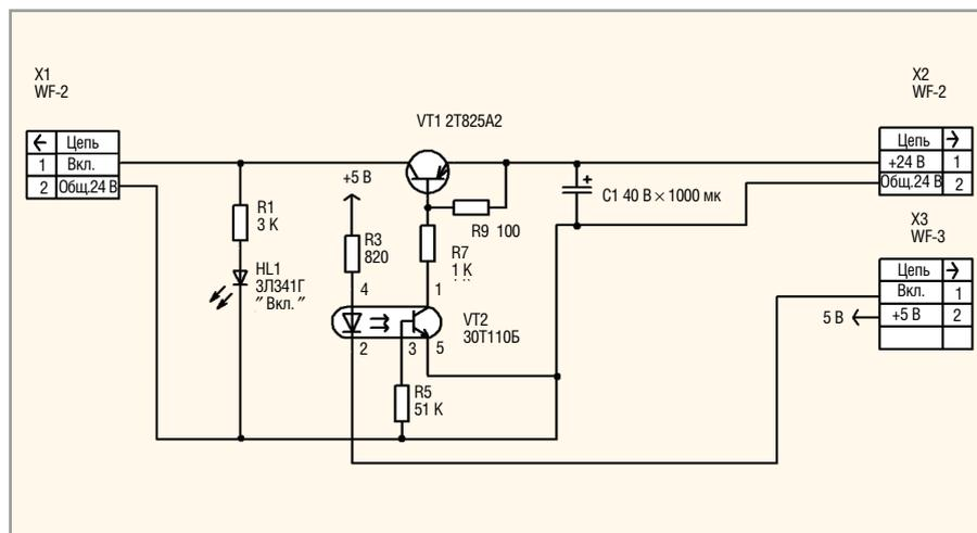
Рис. 4. Схема включения соленоида для втягивания задвигки замков
