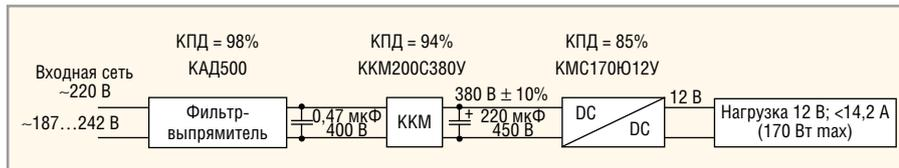
Рис. 11. Электропитание произвольного 12-вольтового потребителя от сети электропитания переменного тока 220 В с коррекцией коэффициента мощности
