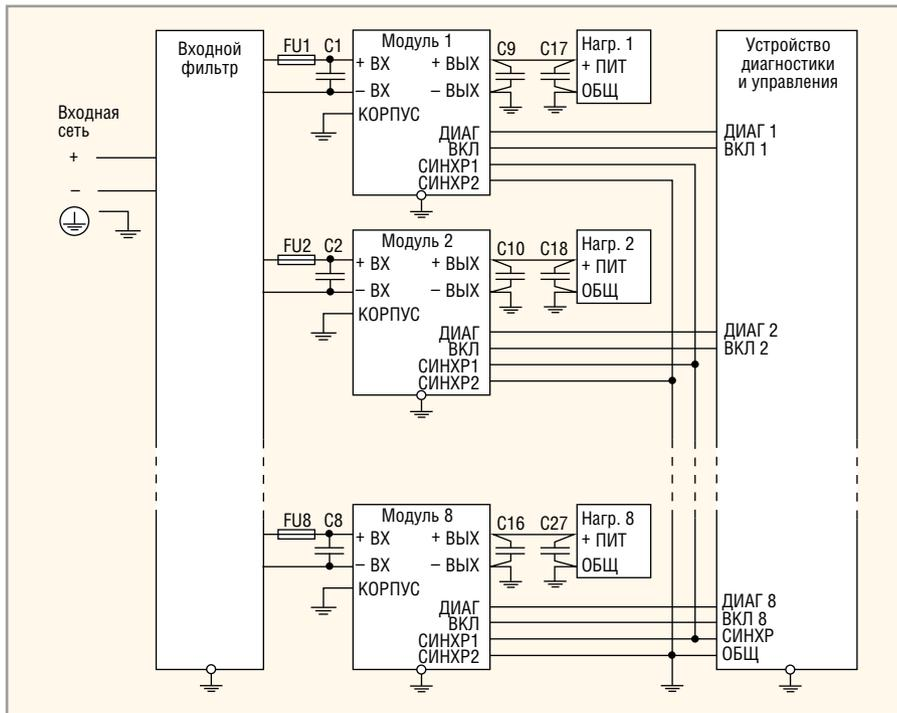
**Рис. 4. Пример реализации децентрализованной системы электропитания с гальванически связанными выходными напряжениями**
