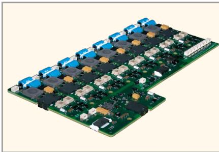
Рис. 5. Система электропитания, построенная на основе модулей «КМС»
