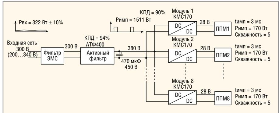
Рис. 7. Активная фильтрация импульсного тока
