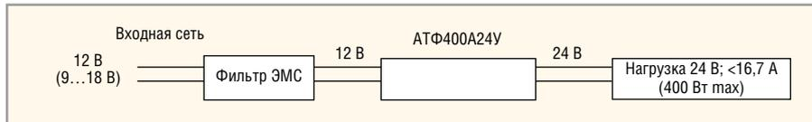
Рис. 9. Использование фильтра «АТФ» в качестве обычного повышающего преобразователя без гальванической развязки
