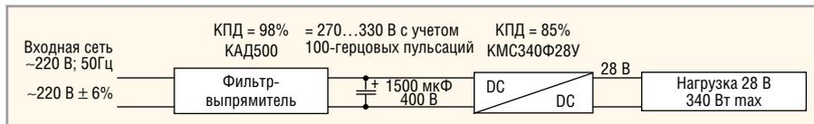
Рис. 12. Реализация AC/DC-преобразователя без коррекции коэффициента мощности
