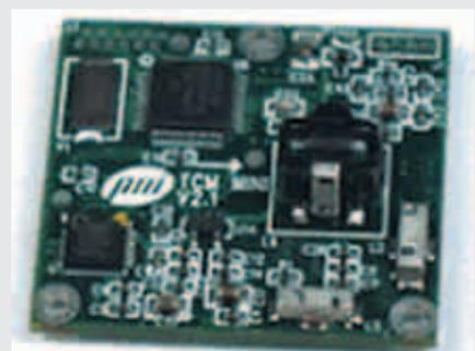
232. При напряжении питания от 3,6 до 5 В ток, потребляемый модулем, не превышает 20 мА. В режиме ожидания ток потребления сокращается до 0,6 мА. Компасный модуль весом 12 г имеет размер  $3,5 \times 4,3 \times 1,3$  см и диапазон рабочих температур  $-40 \dots 85^{\circ}\text{C}$ .
